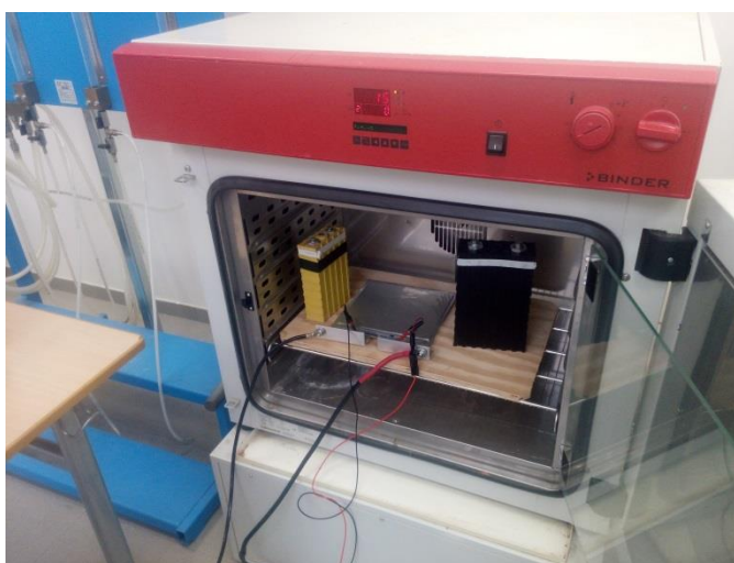
Obrázek 18 - Měřicí pracoviště pro měření článků při zvýšené teplotě
