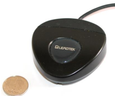
Obrázek 38 GPS modul použitý v traťovém modulu 01, (Autor)
