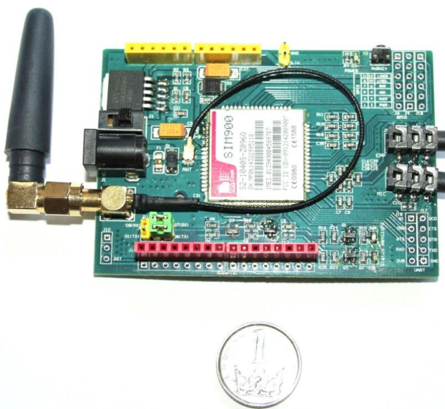
Obrázek 36 GSM modul použitý v traťovém modulu, (Autor)
