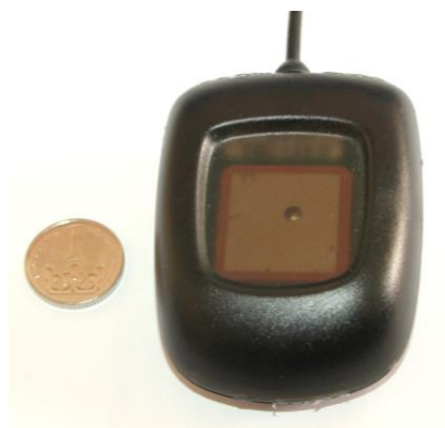
Obrázek 39 GPS modul použitý v traťovém modulu 02, (Autor)
