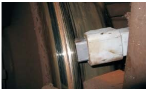
Obr. 9 Systém mazání okolků pomocí tyčinky z tuhého maziva
