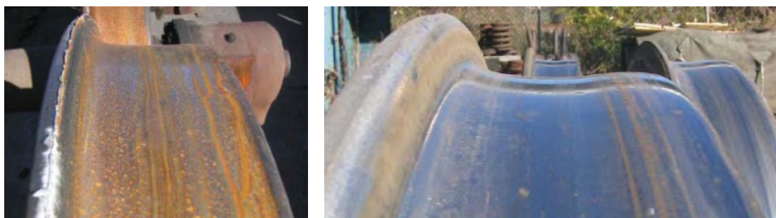
Obr. 19 Pokročilé opotřebení okolku (vlevo) a jízdní plochy (vpravo)
