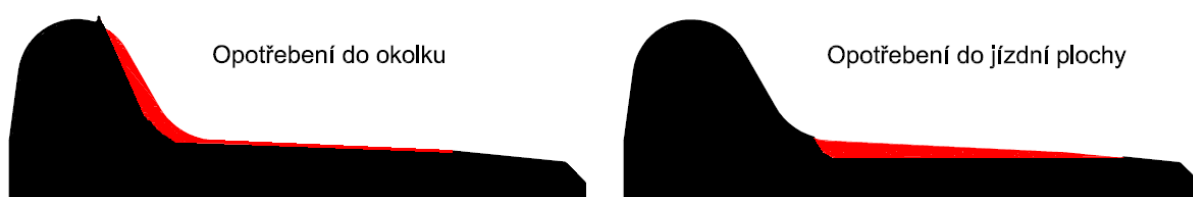
Obr. 18 Dva základní druhy změny tvaru obrysu kola
