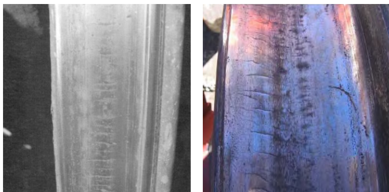
Obr. 14 Teplotní trhliny (vlevo) a trhliny vzniklé mechanickým namáháním (vpravo)
