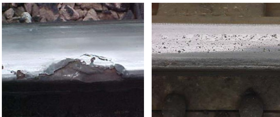
Obr. 11 Shelling (vlevo) a flaking (vpravo)
