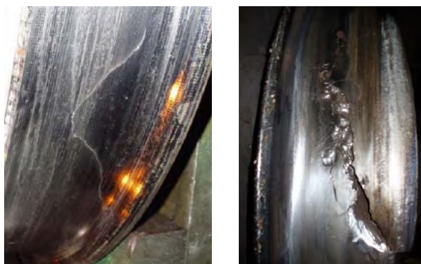
Obr. 15 Trhlina na jízdní ploše způsobené materiálovou vadou (pozdní fáze)
