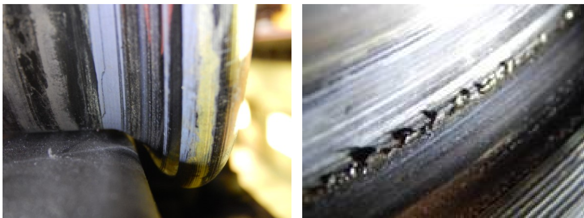
Obr. 7 Detail opotřebeného jízdního obrysu Kužel
