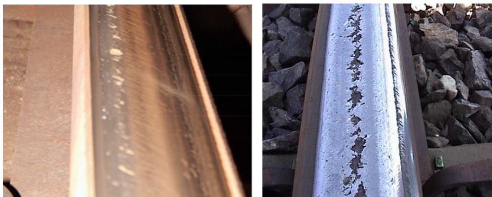
Obr. 12 Head checking v prostředí metra (vlevo) a spalling (vpravo)
