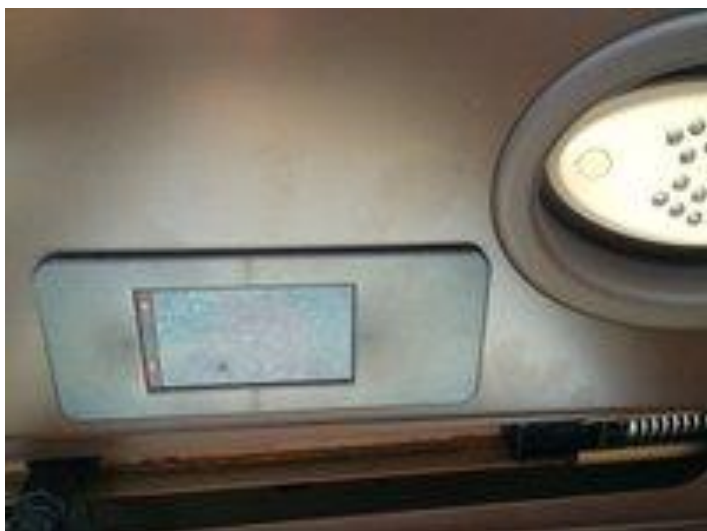
Obrázek 12: APC senzor na principu infračervených paprsků (Abirail, 2016)
