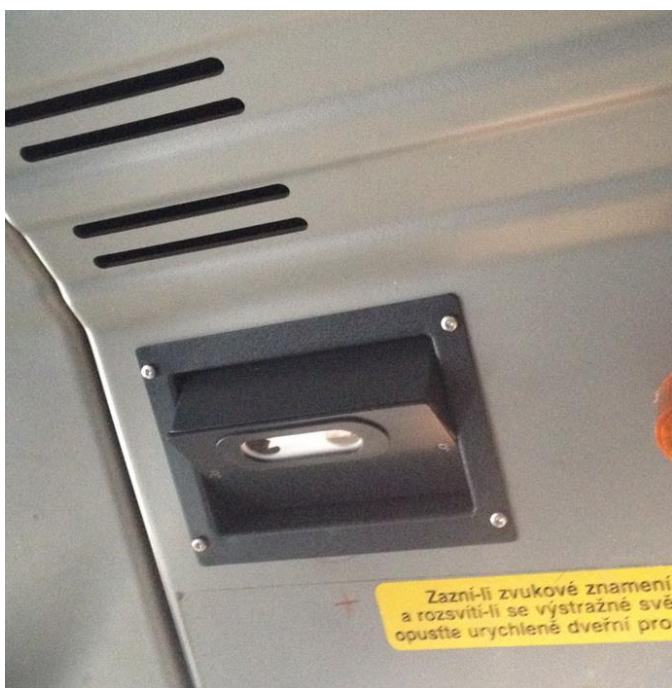
Obrázek 13: APC senzor na principu kamerového systému (Herman, 2016)
