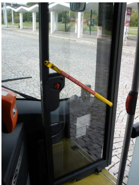
Obrázek 15: Úzké přední dveře vozidla Solaris Urbino 8,9 LE (autor)
