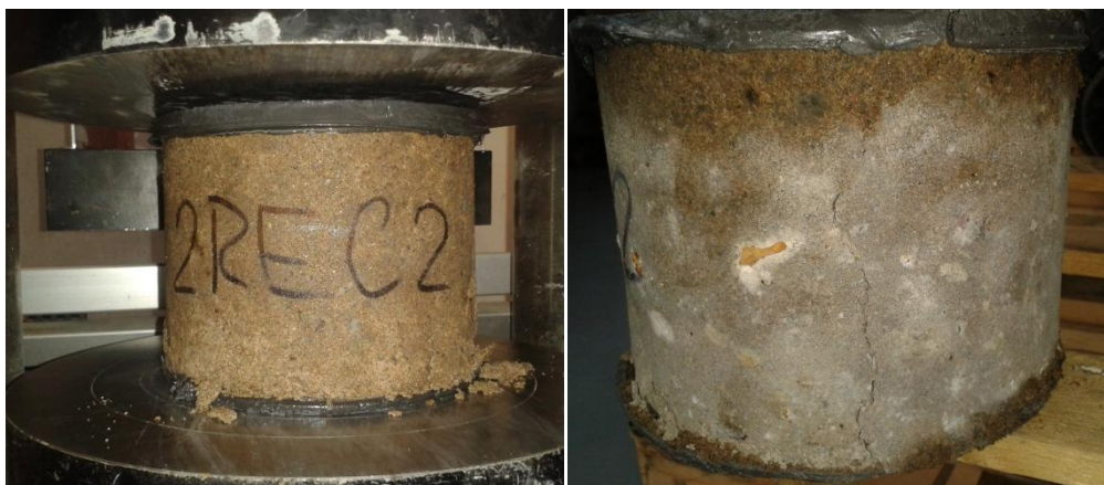
Obrázek 33 – Zkušební tělesa po zkoušce pevnosti v prostém tlaku; REC 2 (vlevo), REC 1 (vpravo)
