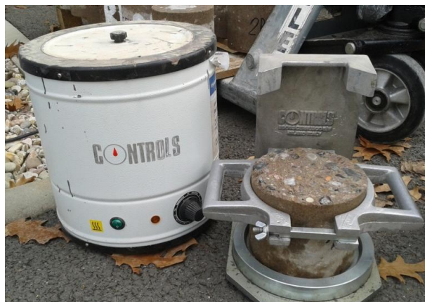
Obrázek 22 – Tavicí kotlík CONTROLS pro koncování sirnou maltou (vlevo), podstavec s držákem válcového zkušební tělesa (vpravo)
