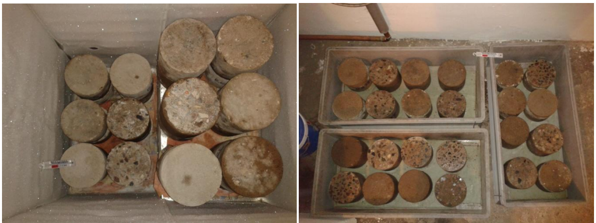
Obrázek 32 – Zkušební tělesa při zkoušce odolnosti proti působení mrazu a vodě – vlevo fáze mražení, vpravo fáze oteplování
