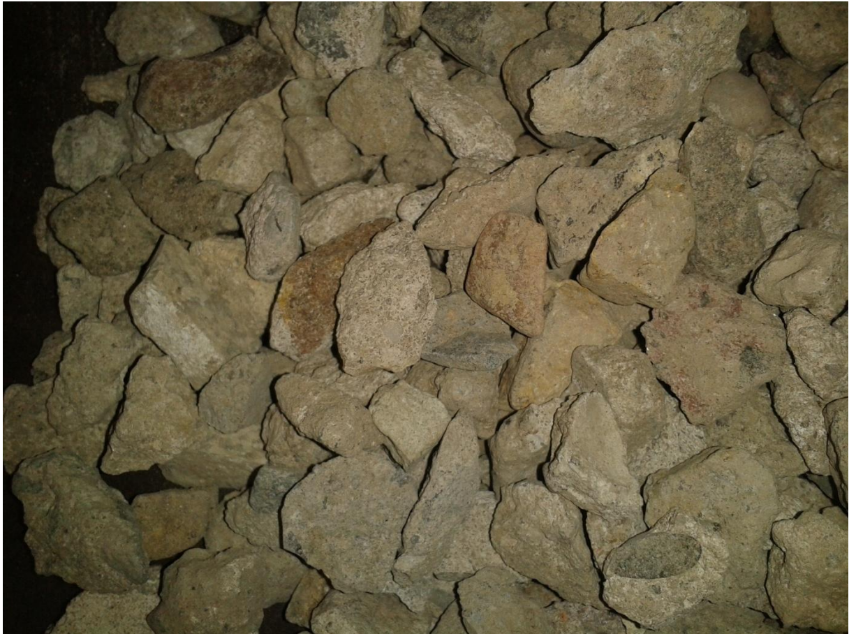
Obrázek 36 – Detail betonového recyklátu REC 2
