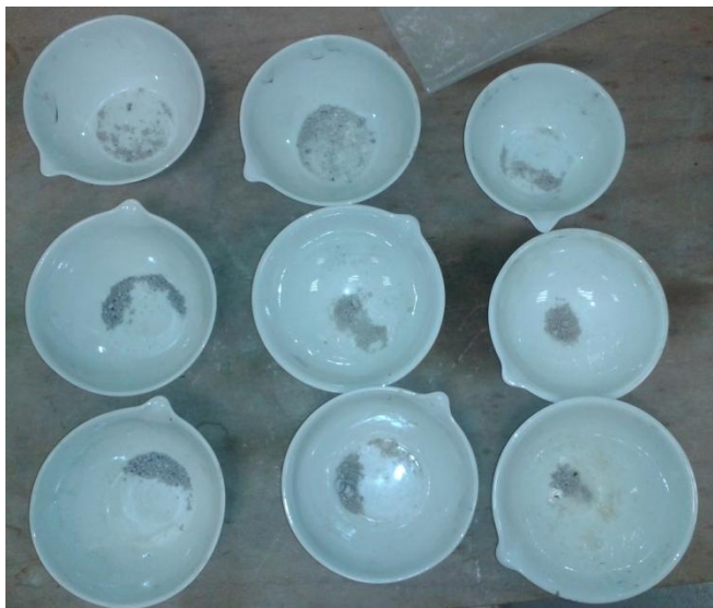
Obrázek 34 – Vysušené hmotnostní odpady směsí (REF, REC 1, REC 2) po 25. cyklu
