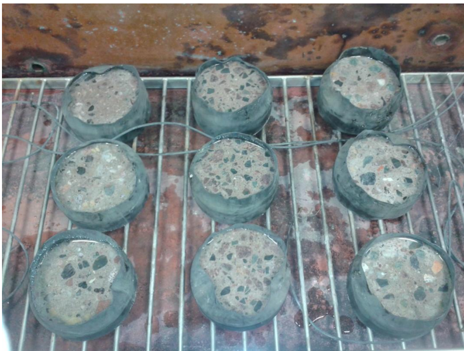
Obrázek 37 – Připravená zkušební tělesa pro zkoušku odolnosti povrchu proti působení vody a CHRL v automatickém cyklovacím zařízení KD 20.3
