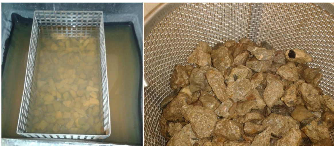
Obrázek 27 – Zkouška nasákavosti, betonový recyklát REC 1 (vlevo), betonový recyklát REC 2 (vpravo)
