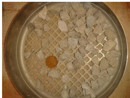
Obrázek 25 – Zachycená zrna betonového recyklátu na síť velikosti 8 mm
