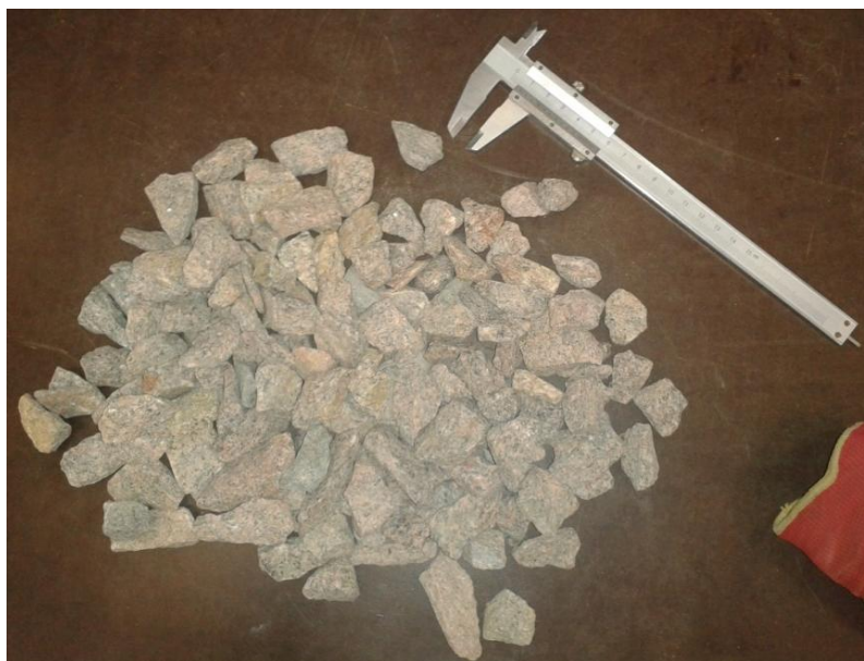
Obrázek 28 – Zkušební navážka frakce 16/22 drceného kameniva s posuvným měřítkem
