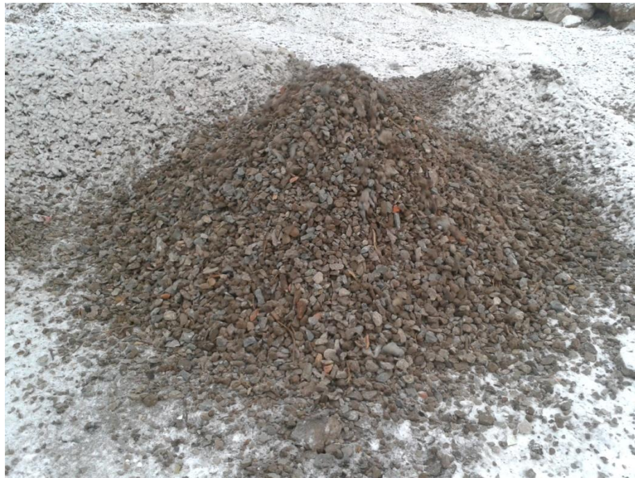
Obrázek 8 – Betonový recyklát frakce 16/32
