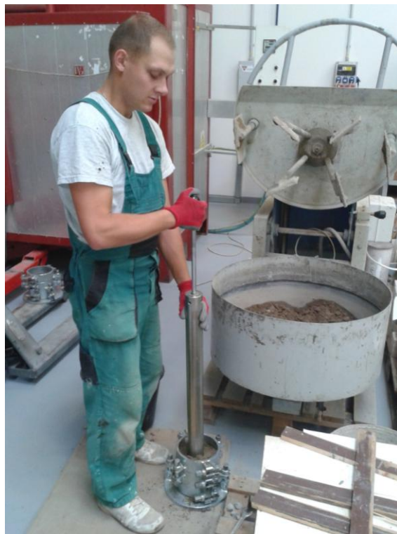
Obrázek 15 – Ruční hutnění stmelěné směsi cementem pomocí hutnícího pěsthu (B)
