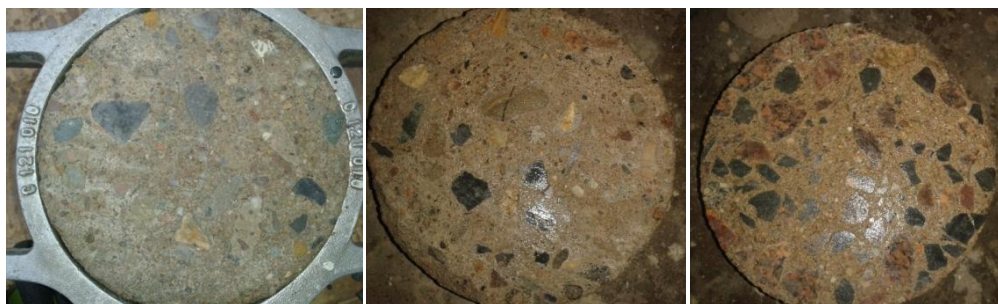
Obrázek 38 – Ukázky povrchu zkušebních těles vzniklého řezem kotoučové pily; směs REC 1 (vlevo), směs REC 2 (uprostřed), směs REF (vpravo)
