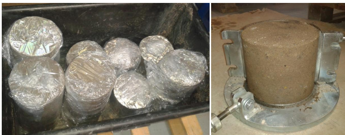
Obrázek 17 – Zabalená zkušební tělesa ve folii během zrání (vlevo), vyhotovené zkušební těleso při odformování (vpravo)
