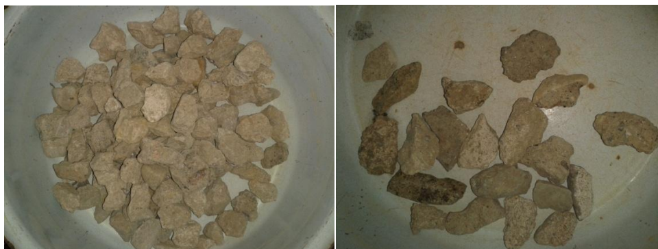
Obrázek 29 – Kubická zrna (vlevo), nekubická zrna (vpravo)
