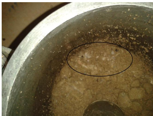
Obrázek 35 – Detail rozdrcení zrna betonového recyklátu při hutnění
