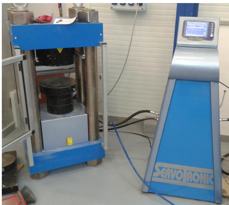
Obrázek 21 – Zkušební lis Matest s řídicí jednotkou Servotronic
