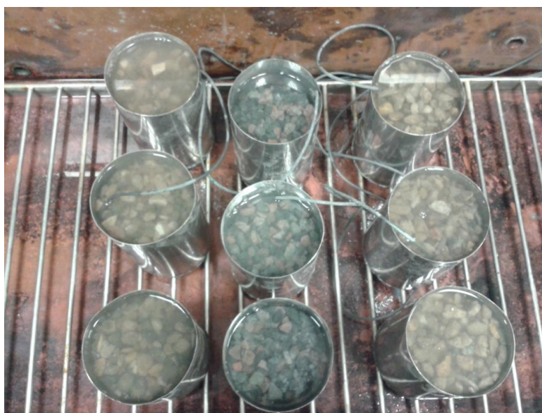
Obrázek 30 – Zkušební vzorky při zkoušce odolnosti kameniva a betonového recyklátu proti působení zmrazování a rozmrazování – REC 1 (vlevo), REF (uprostřed), REC 2 (vpravo)
