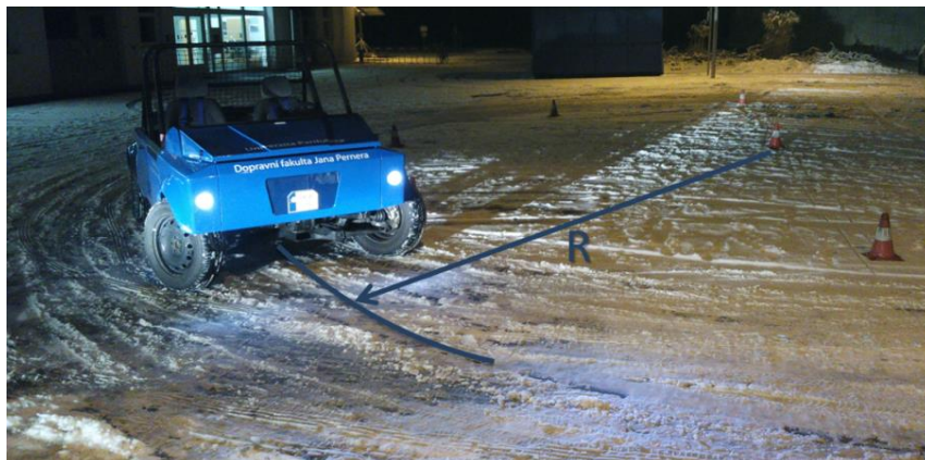
Obr. 3 - Jízdní zkouška za snížených adhezních podmínek
