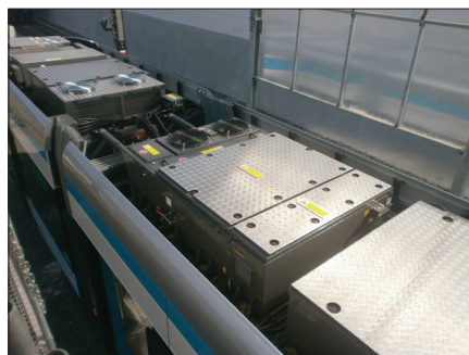
Obr. 9. Pohled na akumulátorový kontejner na střeše tramvaje 28T2 s kombinovaným napájením z troleje a z akumulátorů z produkce Škoda Transportation, a. s. – na kontejneru jsou patrné výstupy ventilačních jednotek
