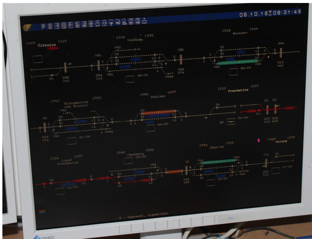
Obrázek I.1JOP s RBS v autonomní dopravně ŽST Prachatice na trati Čičenice – Volary
