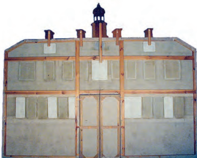
Obr. 4 Kulisa Červený Dvůr, rubová strana, stav po prvním restaurování v 80. letech 20. století. Plátno je osazeno na nový rám, část průsvitů je podlepena neprůsvitným plátnem. (Archiv Státního bradu a zámku Český Krumlov)
