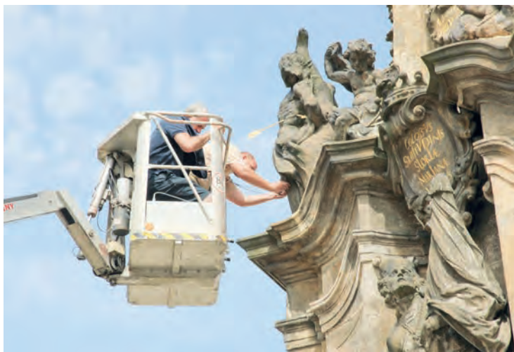
Obr. 5 Polička, mariánský sloup, měření metodou ultrazvukové transmise, na snímku v koši vysokozdvížečné plošiny K. Bayer, P. Gläser. (Foto Z. Gläserová Lebedová, 2012)
