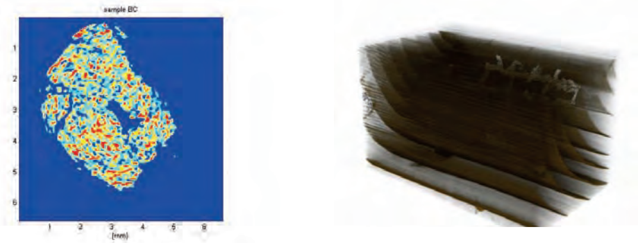
Obr. 6 a, b Levá část ukazuje příklad počítačové tomografie pórové struktury bentonitové odsolovací omítky, pravá část příklad biologicky poškozeného dřeva.
