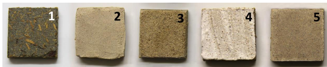
Obr. 4: Ukázka aplikace omítky na cetrisové destičky. 1 – zvlhčená cetrisová destička, 2 – cetrisová destička s nanесenou vápennou omítkou, 3 – stržený povrch omítky, 4 – aplikace vápenného nátěru, 5 – vkletování vápenného nátěru do povrchu omítky.
