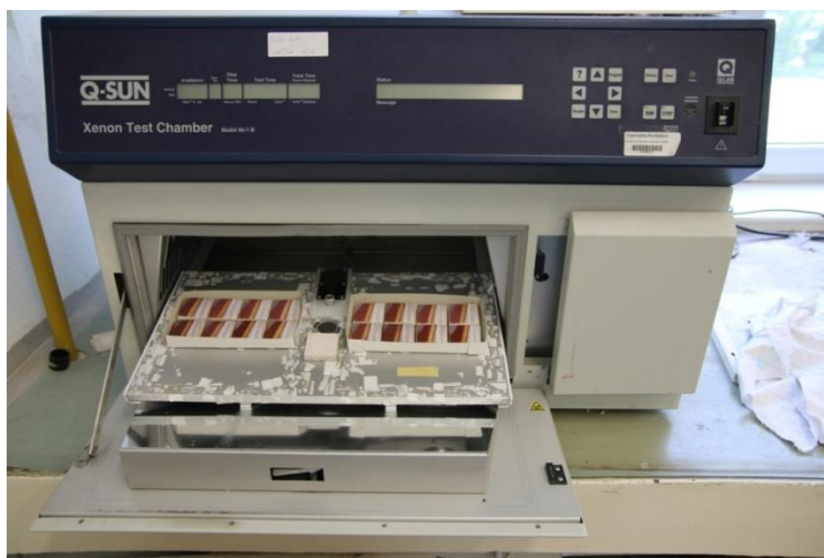
Obr. 13: Umístění dvou sérií vzorků v komoře pro umělé stárnutí Q-Sun Xenon Test Chamber .
