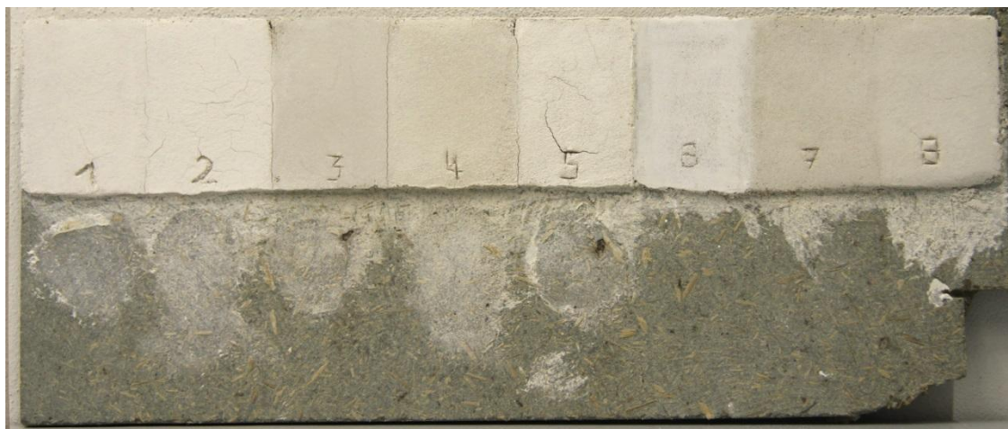
Obr. 3: Zkoušky přípravy omítkového podkladu na cetrisové desce.
