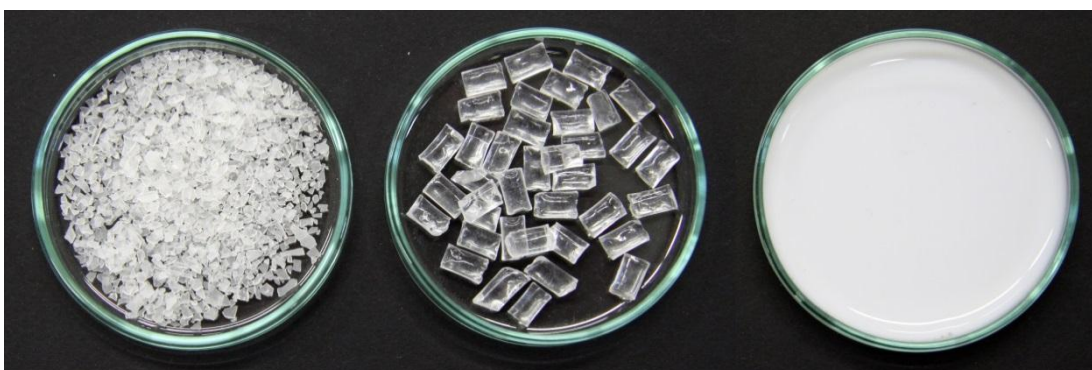
Obr. 2: Vybraná pojiva. Zleva: polyvinylalkohol Mowiol 4-88 , akrylátová pryskyřice Paraloid B-72 , akrylátová disperze Disepression K9 . Průměr Petriho misky – 6 cm.
