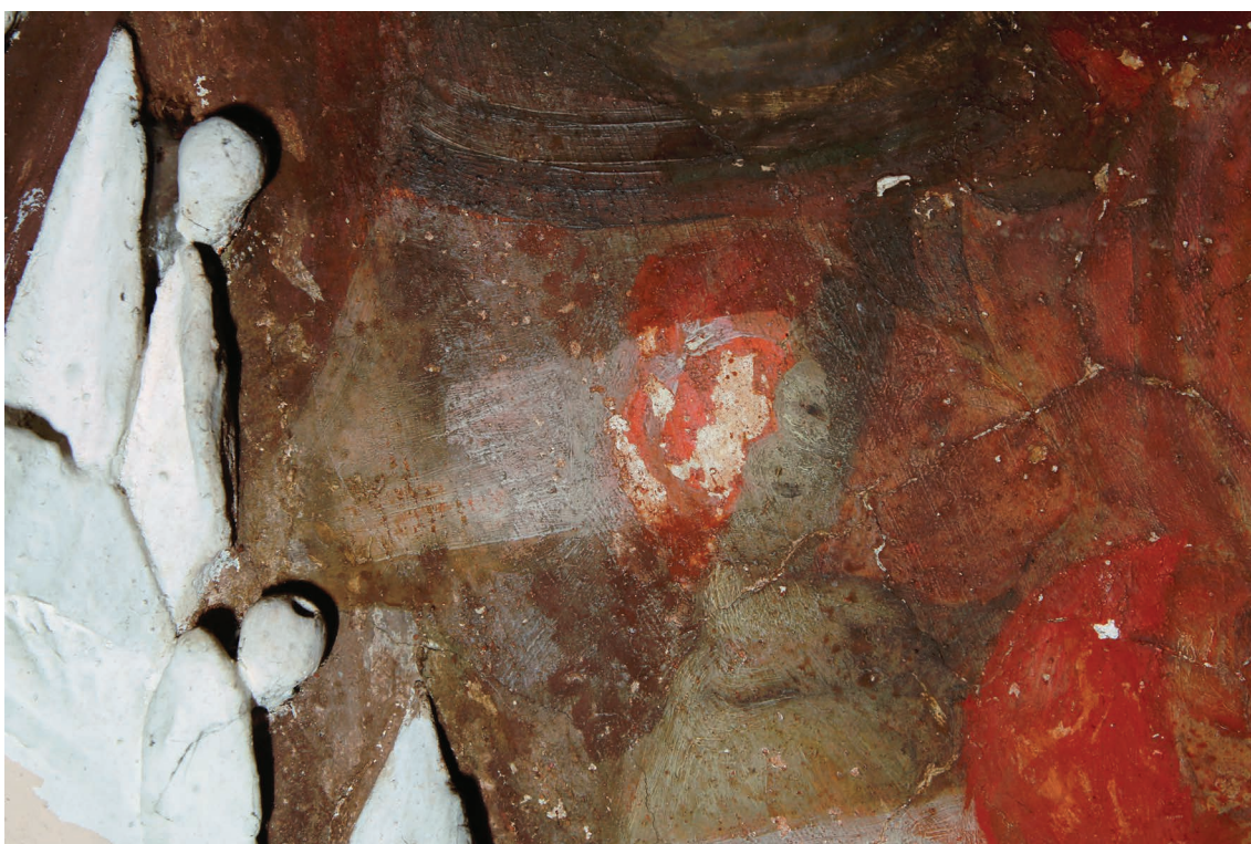
Obr. 33: Detail maľby v klenbe kaplnky (svätováclavský cyklus). Skúška čistenia v oblasti hlavy muža a pozadia, pomocou čistiaceho Carbopol gelu, po dobe pôsobenia max. 10 minút bol odmytý pomocou acetónu.
