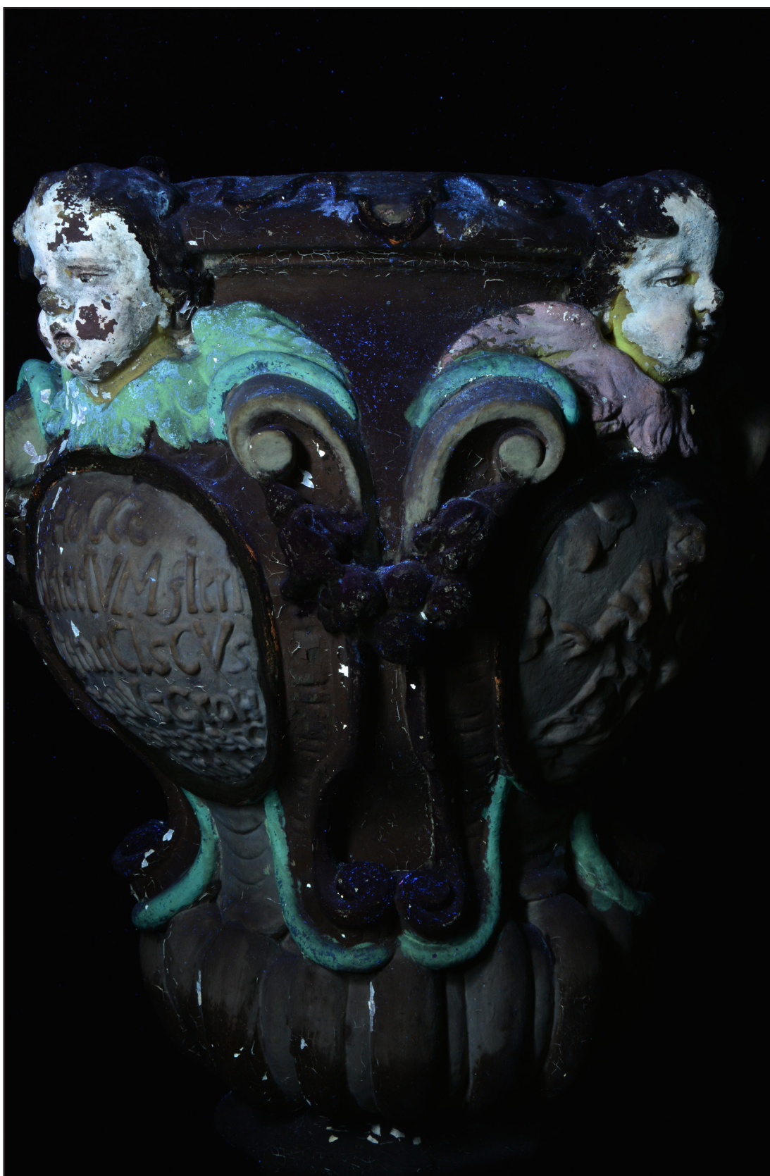
Obrázek 18 - Detail rozdílné luminiscence dílčích částí polychromování. UV lampa Hönle UVA SPOT 400T, UVA oblast UV záření, rozmezí 315 až 400 nm.
