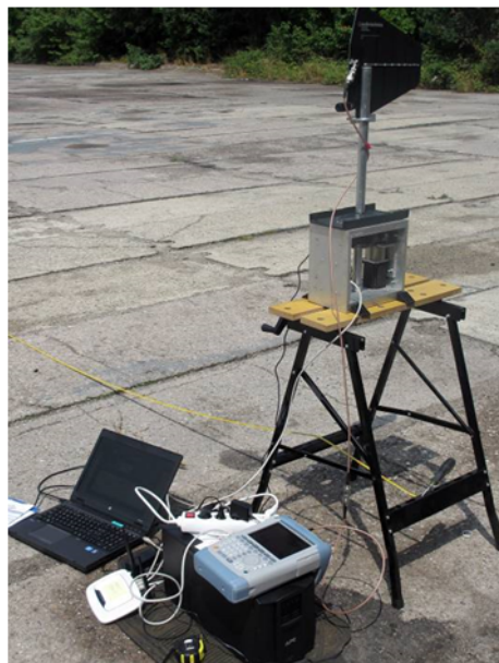
Obr. 4.10 – měření vyzařovací charakteristiky; vysílací (vlevo) a přijímací část (vpravo); zdroj: vlastní
