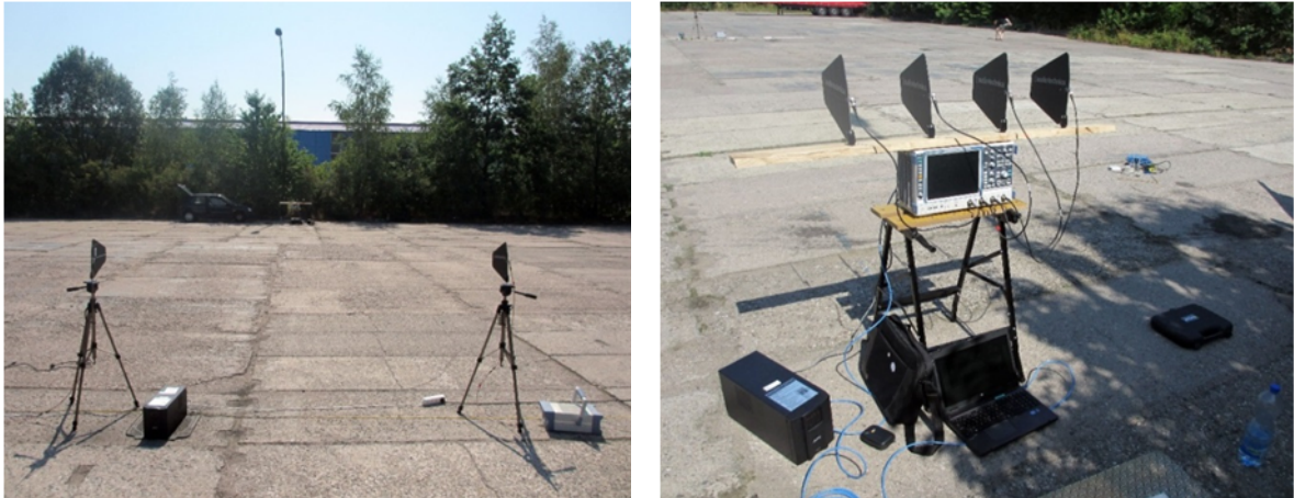
Obr. 4.15 – vysílací (vlevo) a přijímací část (vpravo) měřicího pracoviště; zdroj: vlastní
