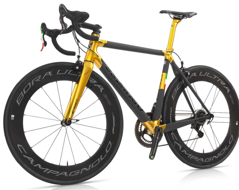
Obrázek 16: Colnago C60 s rámem z kompozitních profilů vlepených do uhlíkových mufen
