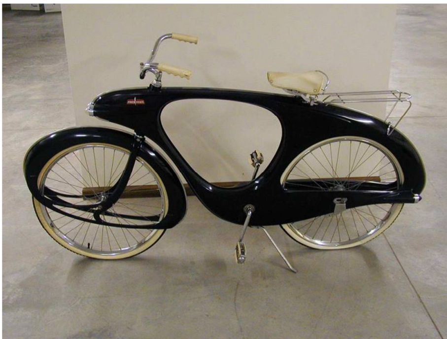
Obrázek 2: Jízdní kolo Bowden Spaceland z roku 1959 se samonosným rámem ze sklolaminátového kompozitu ( www.nostalgic.net )
