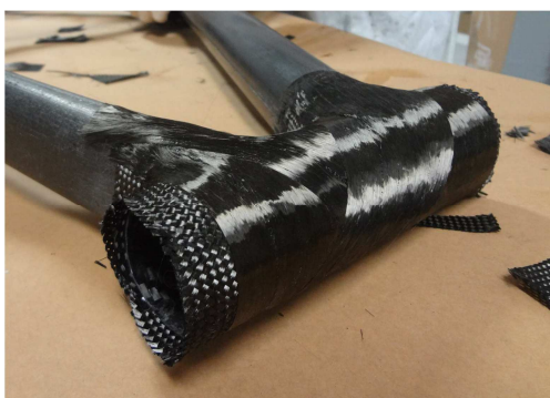
Obrázek 17: Spoj hlavové trubky rámu (foto: Jure Berk)
