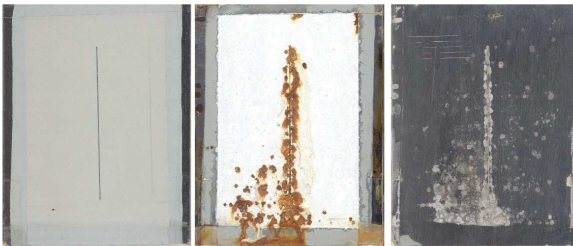
Nátěrové filmy s obsahem Zn lamelární + PANI – H 3 PO 4 při OKP = 1 % před expozicí, po 28 dnech a ocelový panel po odstranění nátěrového filmu.
