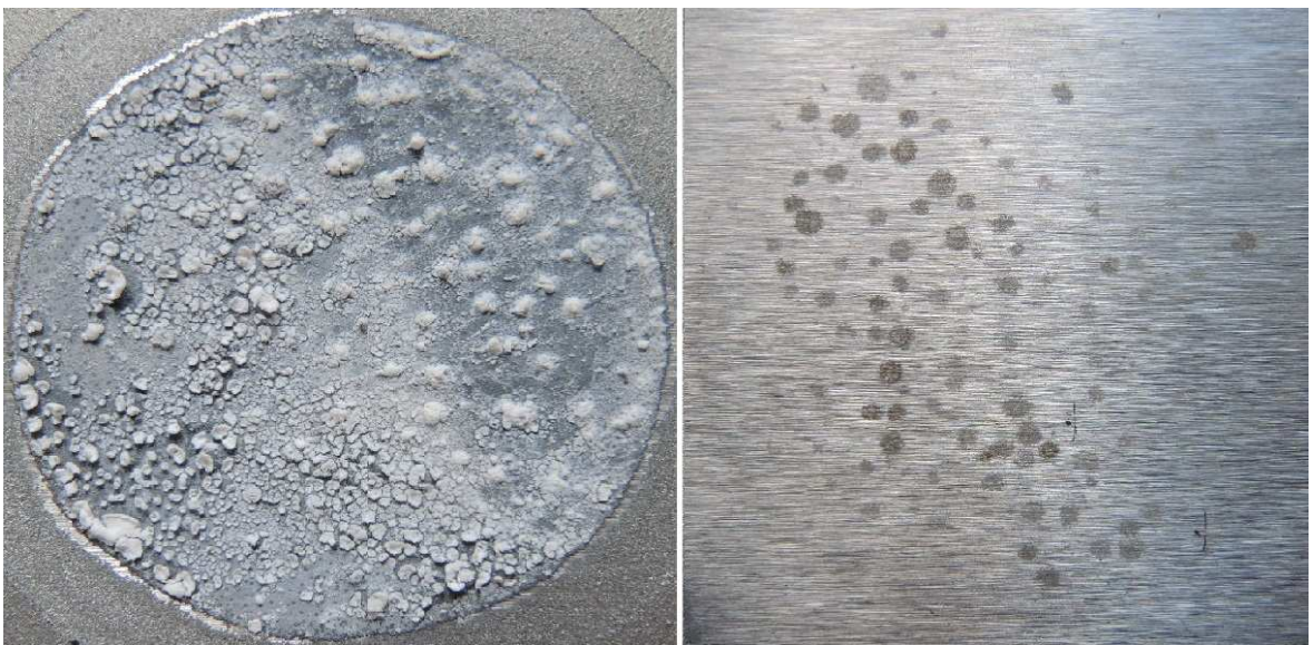
Nátěrový film s obsahem Zn lamelární + PANI – H 3 PO 4 při OKP = 15 % po 480 hodinové expozici a ocelový panel po odstranění nátěrového filmu.
