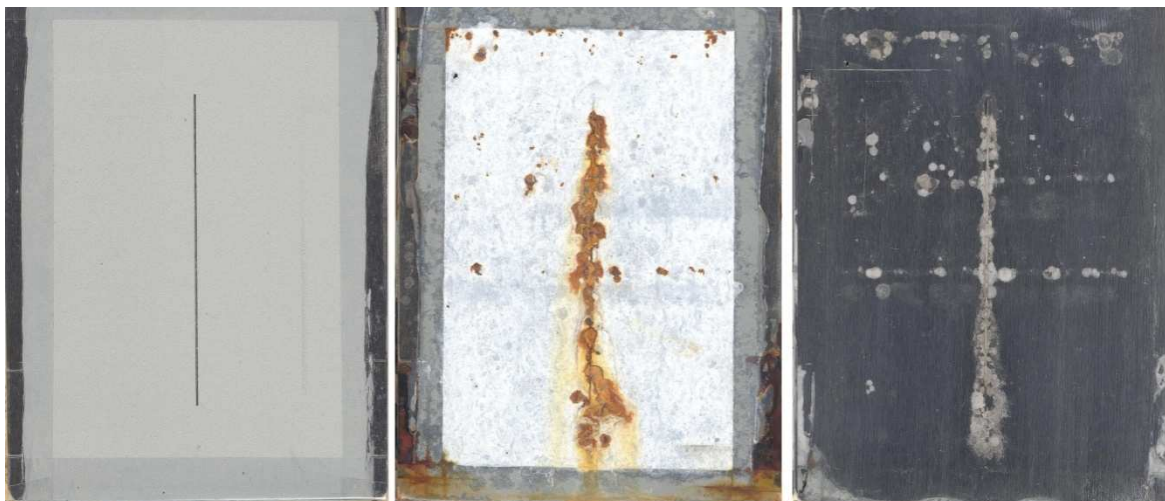
Nátěrové filmy s obsahem Zn lamelární + PANI – H 3 PO 4 při OKP = 15 % před expozicí, po 28 dnech a ocelový panel po odstranění nátěrového filmu.
