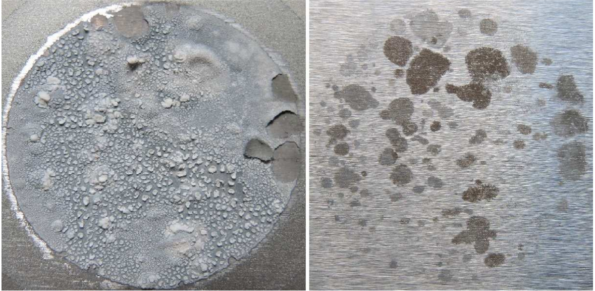
Nátěrový film s obsahem Zn lamelární + PANI – H 3 PO 4 při OKP = 0,5 % po 480 hodinové expozici a ocelový panel po odstranění nátěrového filmu.
