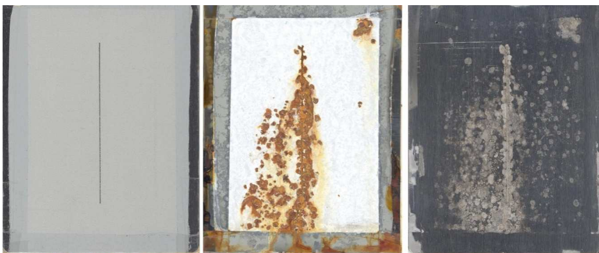
Nátěrové filmy s obsahem Zn lamelární + PANI – H 3 PO 4 při OKP = 3 % před expozicí, po 28 dnech a ocelový panel po odstranění nátěrového filmu.
