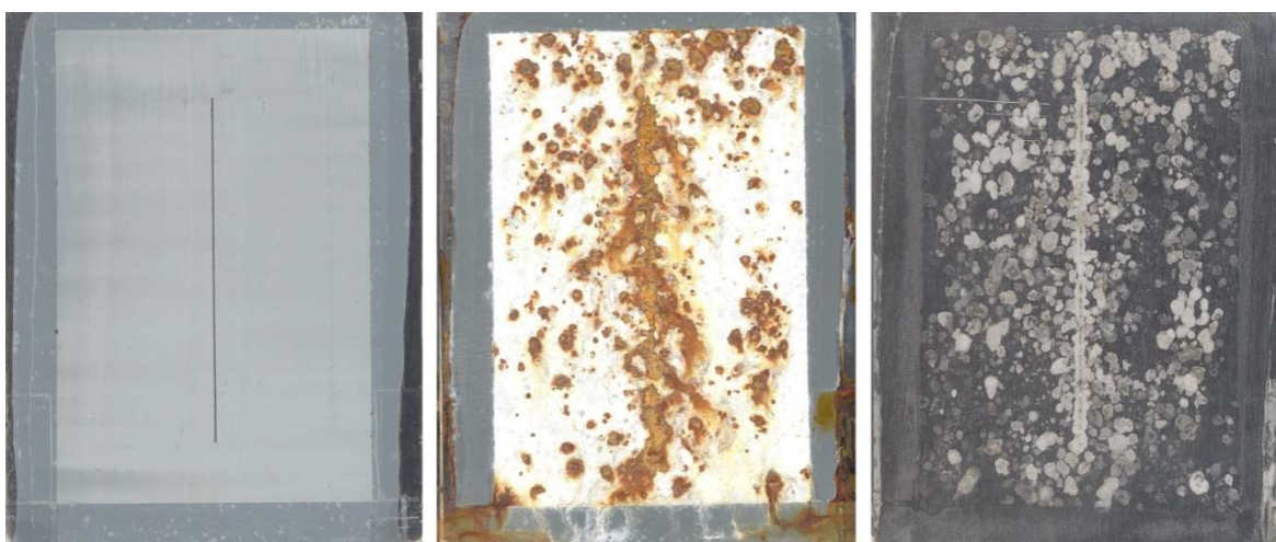
Nátěrové filmy s obsahem Zn sférický + PANI – H 3 PO 4 při OKP = 5 % před expozicí, po 28 dnech a ocelový panel po odstranění nátěrového filmu.
