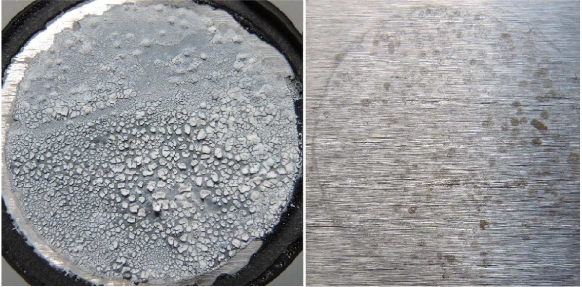
Nátěrový film s obsahem Zn sférický + PANI – H 3 PO 4 při OKP = 3 % po 480 hodinové expozici a ocelový panel po odstranění nátěrového filmu.
