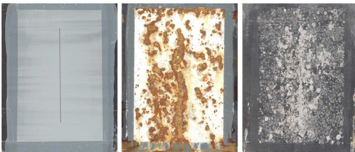
Nátěrové filmy s obsahem Zn sférický OKP = 0 % před expozicí, po 28 dnech a ocelový panel po odstranění nátěrového filmu.
