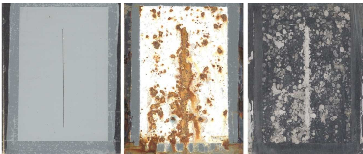
Nátěrové filmy s obsahem Zn sférický + PANI – H 3 PO 4 při OKP = 15 % před expozicí, po 28 dnech a ocelový panel po odstranění nátěrového filmu.
