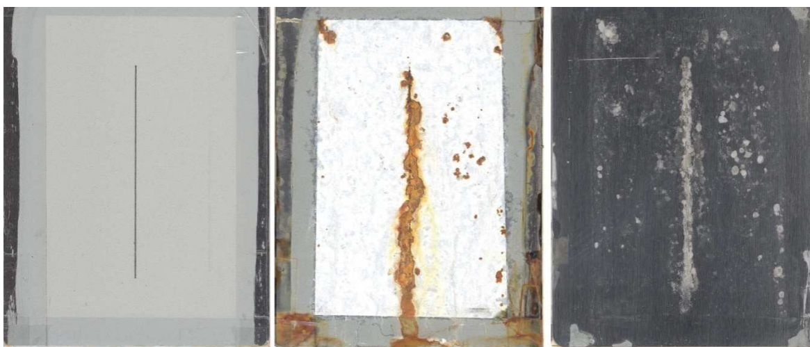
Nátěrové filmy s obsahem Zn lamelární + PANI – H 3 PO 4 při OKP = 10 % před expozicí, po 28 dnech a ocelový panel po odstranění nátěrového filmu.
