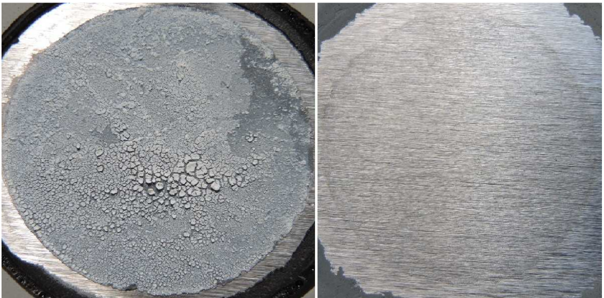
Nátěrový film s obsahem Zn sférický + PANI – H 3 PO 4 při OKP = 15 % po 480 hodinové expozici a ocelový panel po odstranění nátěrového filmu.
