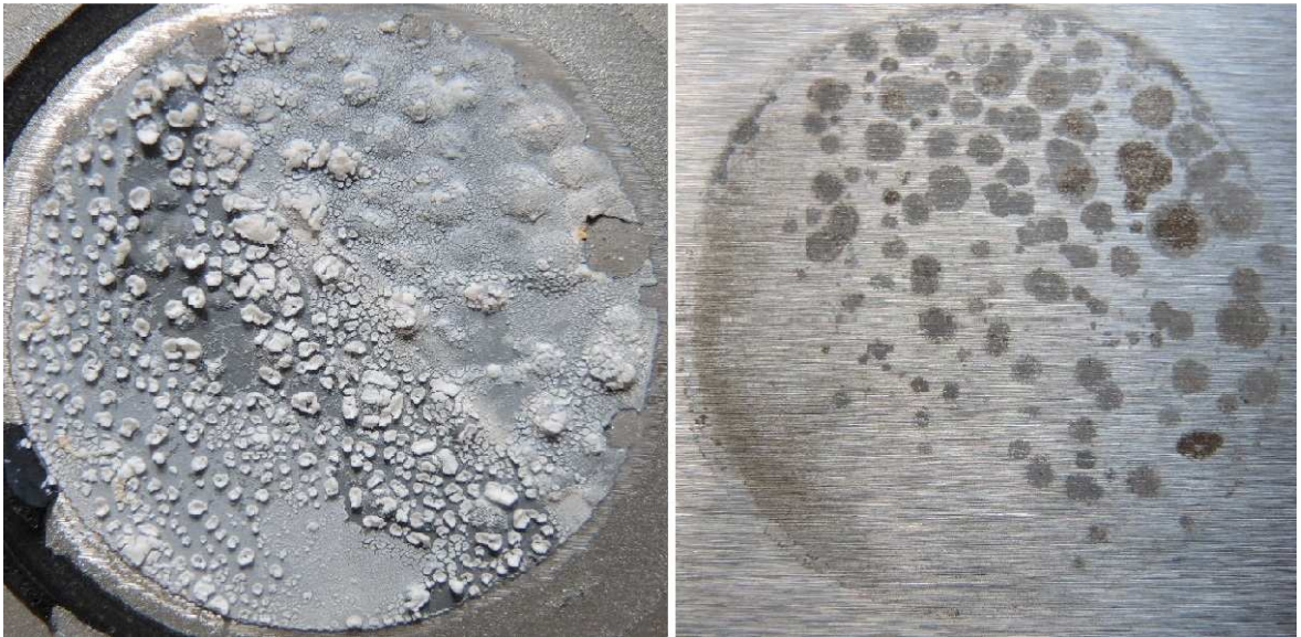
Nátěrový film s obsahem Zn lamelární + PANI – H 3 PO 4 při OKP = 3 % po 480 hodinové expozici a ocelový panel po odstranění nátěrového filmu.
