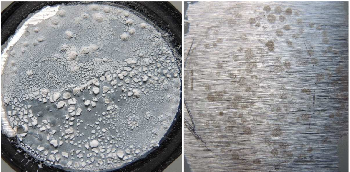
Nátěrový film s obsahem Zn sférický + PANI – H 3 PO 4 při OKP = 5 % po 480 hodinové expozici a ocelový panel po odstranění nátěrového filmu.
