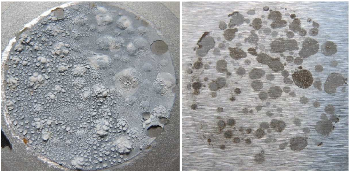
Nátěrový film s obsahem Zn lamelární + PANI – H 3 PO 4 při OKP = 1 % po 480 hodinové expozici a ocelový panel po odstranění nátěrového filmu.
