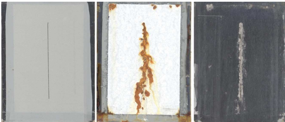
Nátěrové filmy s obsahem Zn lamelární + PANI – H 3 PO 4 při OKP = 5 % před expozicí, po 28 dnech a ocelový panel po odstranění nátěrového filmu.
