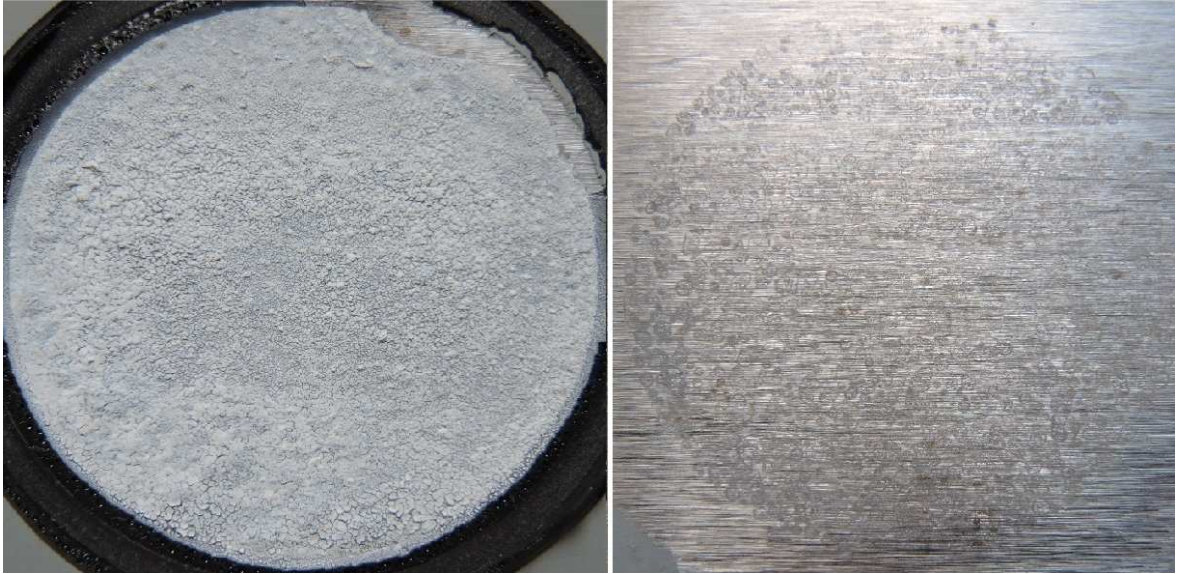
Nátěrový film s obsahem Zn sférický + PANI – H 3 PO 4 při OKP = 0,5 % po 480 hodinové expozici a ocelový panel po odstranění nátěrového filmu.
