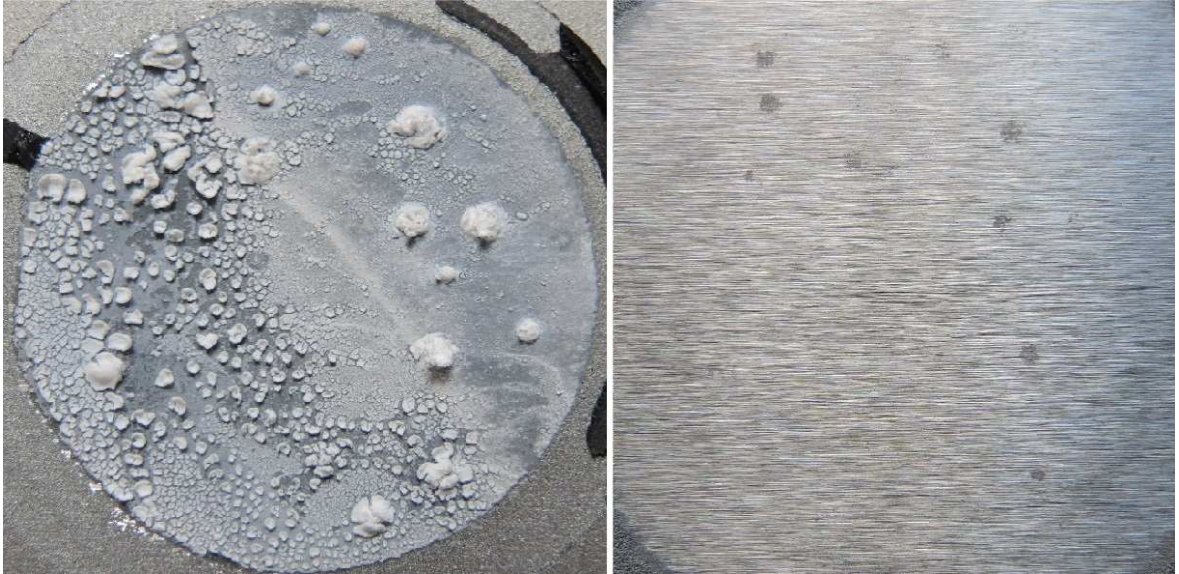
Nátěrový film s obsahem Zn lamelární + PANI – H 3 PO 4 při OKP = 10 % po 480 hodinové expozici a ocelový panel po odstranění nátěrového filmu.
