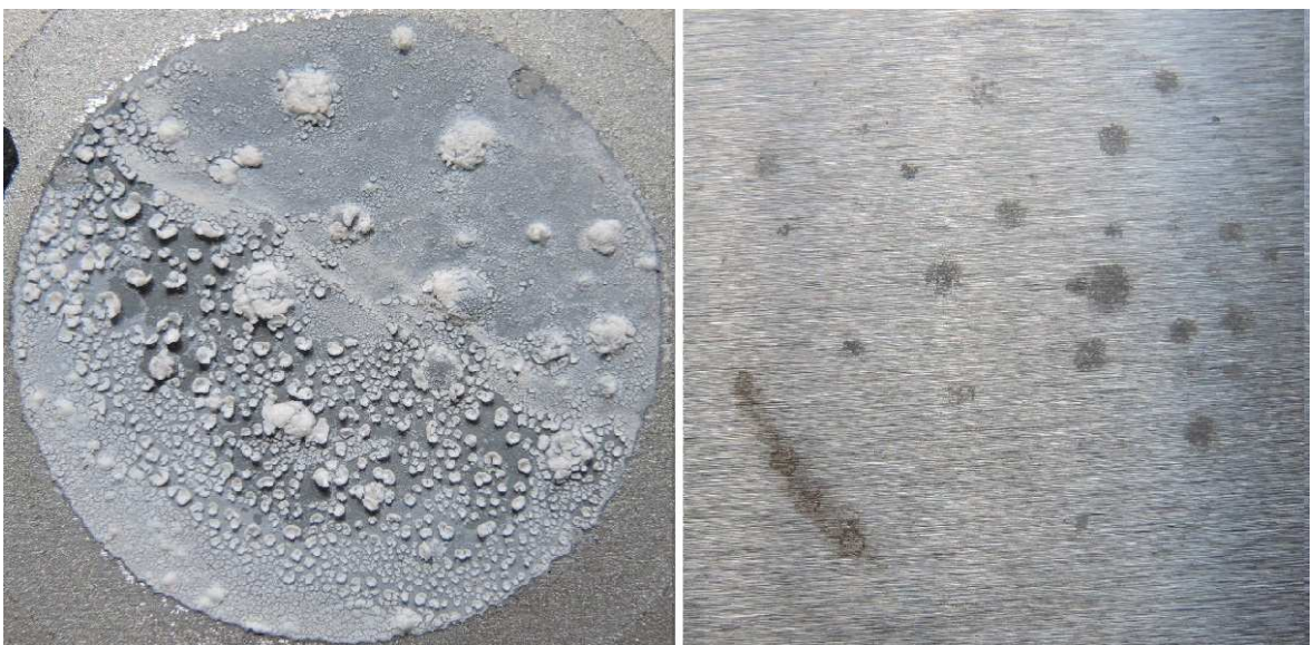
Nátěrový film s obsahem Zn lamelární + PANI – H 3 PO 4 při OKP = 5 % po 480 hodinové expozici a ocelový panel po odstranění nátěrového filmu.
