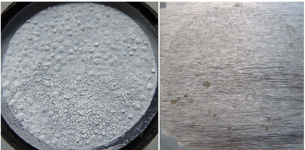
Nátěrový film s obsahem Zn sférický + PANI – H 3 PO 4 při OKP = 1 % po 480 hodinové expozici a ocelový panel po odstranění nátěrového filmu.
