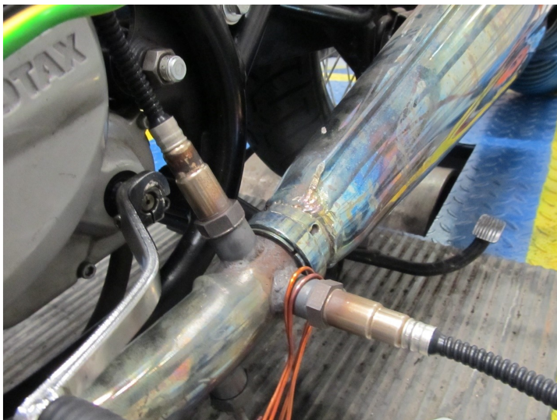
Obrázek 4.2 Detail připojení lambda sond na motocykl
