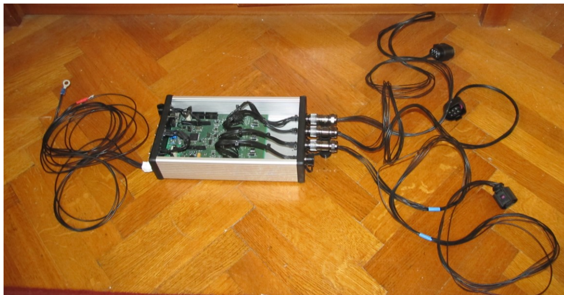
Obrázek 2.48 Vzhled hotového převodníku s kabeláží
