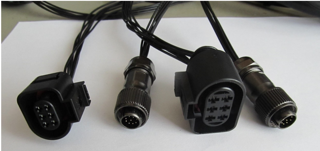
Obrázek 2.46 Srovnání kabelových svazků LSU 4.9 (vlevo) a LSU 4.2
