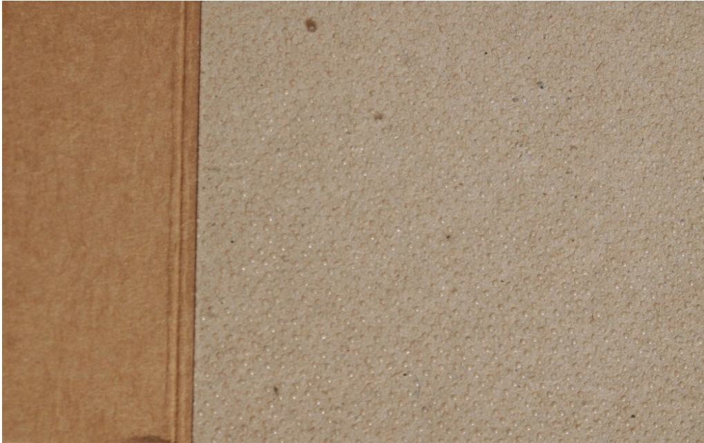
Obrázek 26 Protiskluzová úprava SlipSheet podložky (Sopack, 2016)
