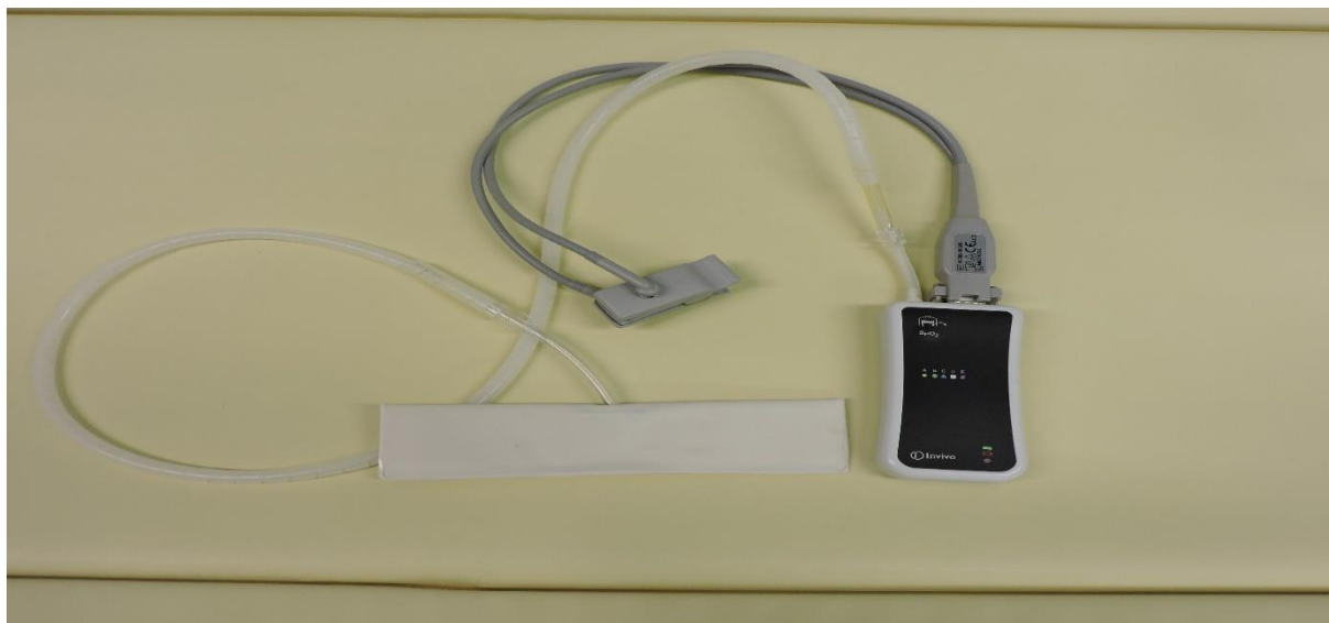
Obrázek 9 Modul pro bezdrátový přenos respiračních pohybů a pulsní oxymetr
