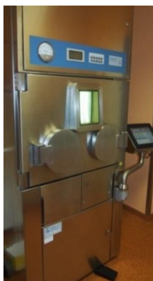
Obrázek 12 Stíněná digestoř s automatickým dávkovačem (zdroj: autor)
