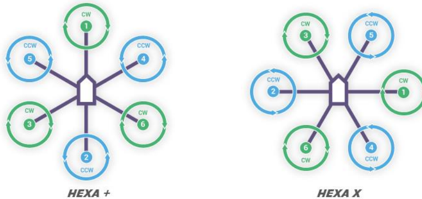
Obrázek 5 Hexakoptéra řazení motorů (+) a řazení motorů (X) [4]
