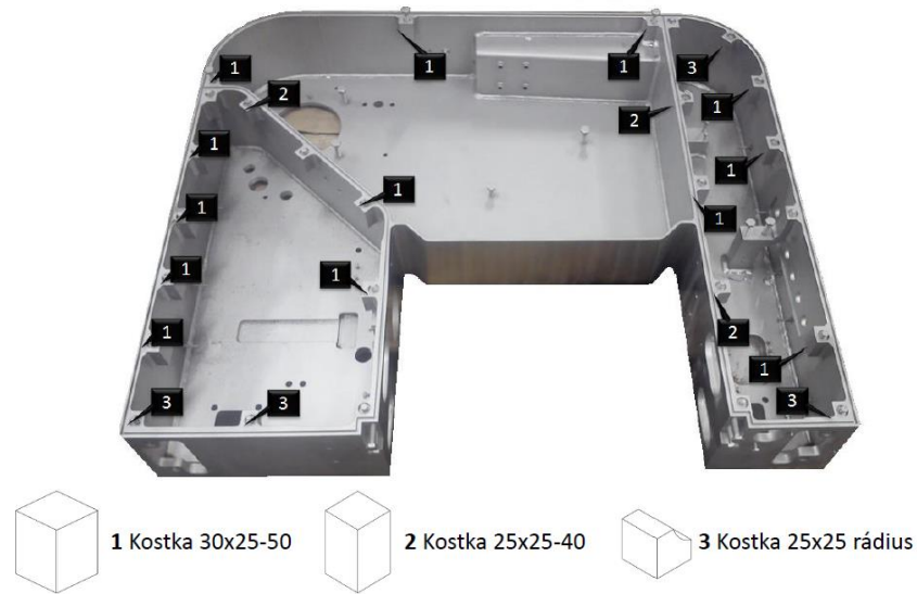
Obrázek 23 Návodka umístění kostek výrobku „Gehäuse 4016069453 – Schneidkopf“
