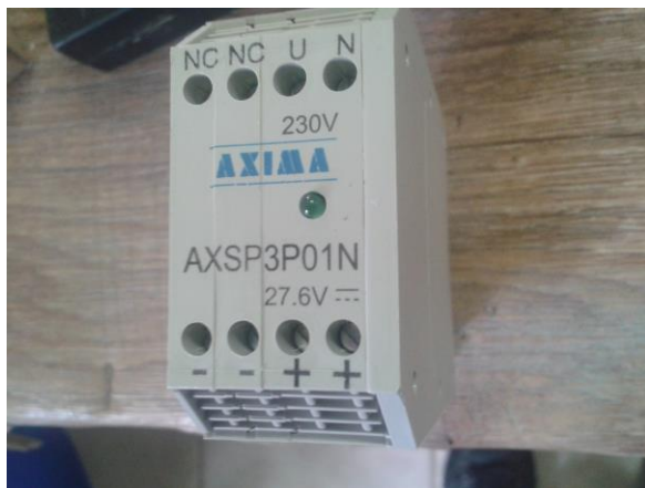
Obr. 3.4 – Spínaný stabilizovaný zdroj AXSP3P01
