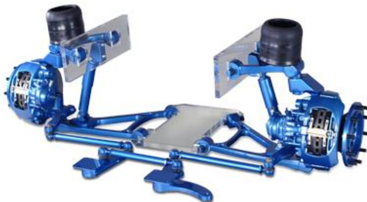
Obrázek 26 - Voith IFS TJ81-225 – nezávislé zavěšení předních kol [19]
