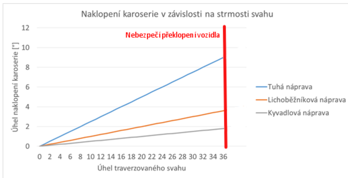
Obrázek 12 - Naklopení karoserie vozidla při traverzování [vlastní]
