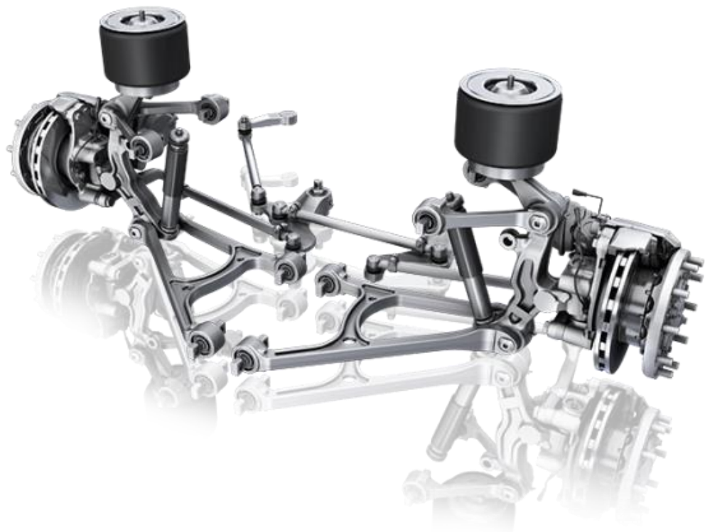
Obrázek 18 - ZF RL 82 EC – nezávislé zavěšení předních kol [10]
