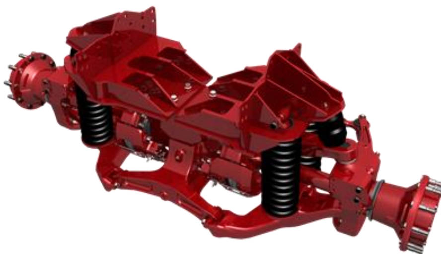
Obrázek 28 - Hendrickson ISAS – nezávislé zavěšení kol [20]
