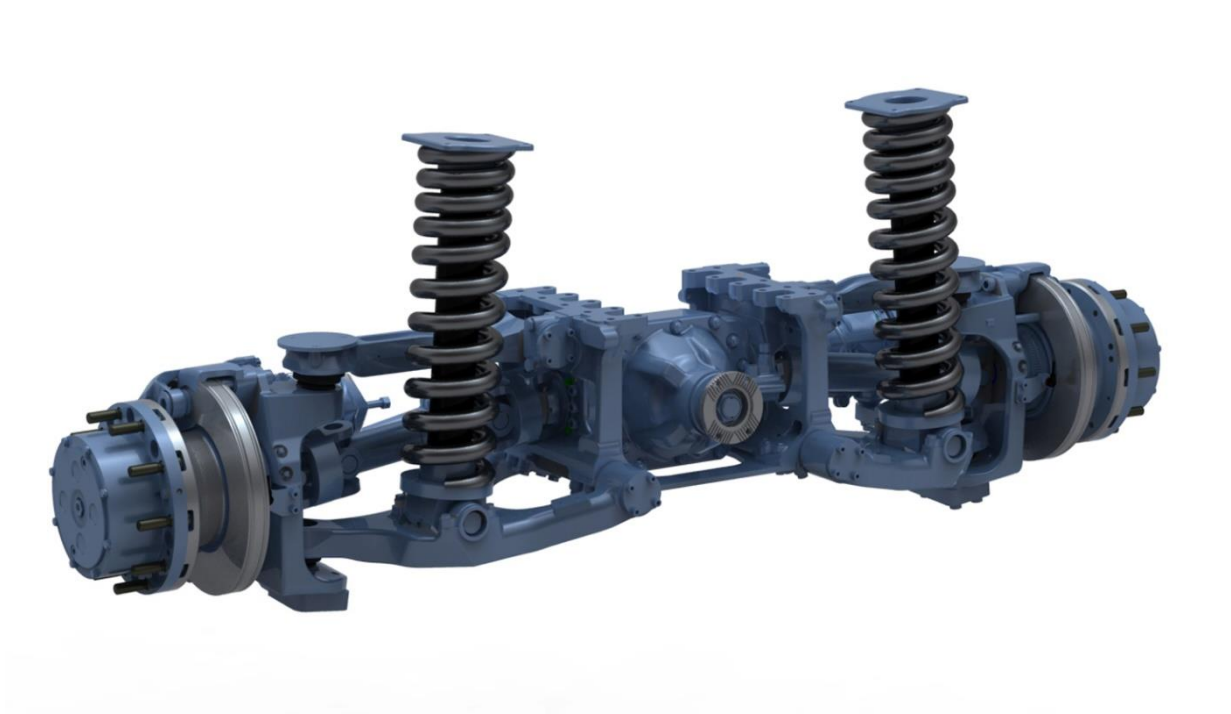
Obrázek 20 - AxleTech ISAS 4500 – nezávislé zavěšení kol [13]
