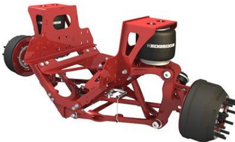
Obrázek 27 - Hendrickson IFS – nezávislé zavěšení předních kol [20]
