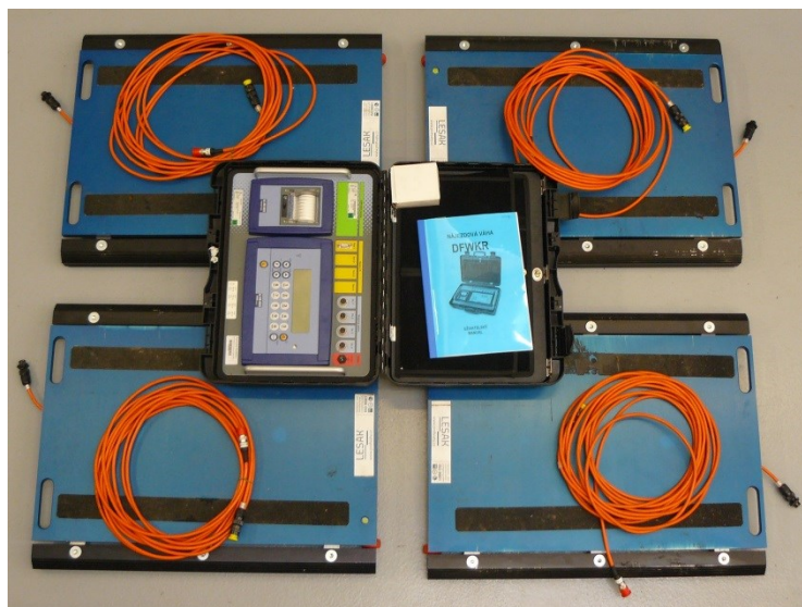
Obrázek 23: Nájezdové platformy a vážní jednotka
