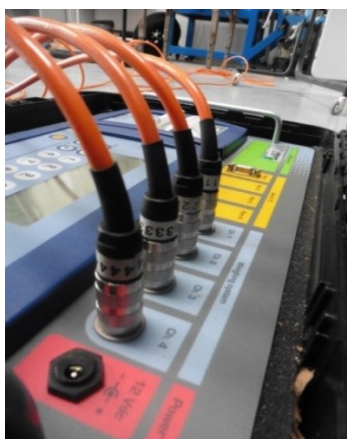
Obrázek 6: Ukázka zapojení kabelů do ústředny
