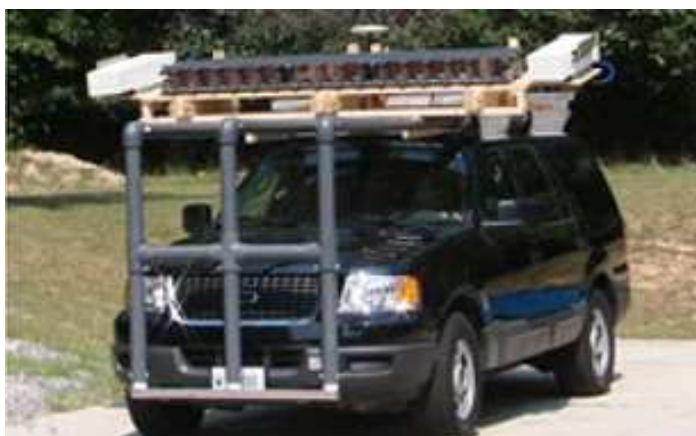
Obr. 1.11 UWB radar pro detekci stěn v budově [37].
