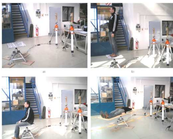
Obr. 4.7 Měření odrazivosti osoby. a) točna, b) ve stoje, c) v sedě, d) v leže.
