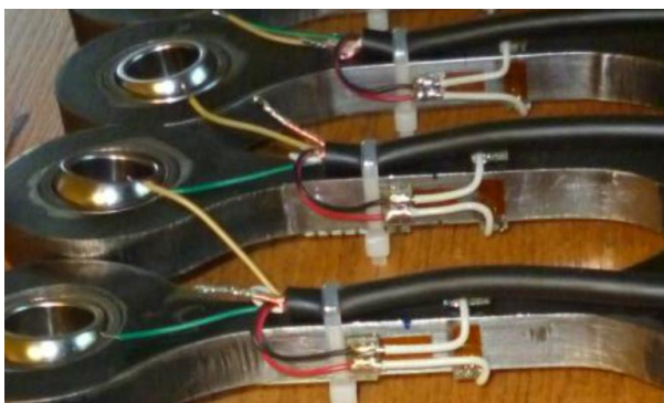
Obr. 5.7 – Ojničky osazené tenzometry před kalibrací (2),(3) a (4) [2]
