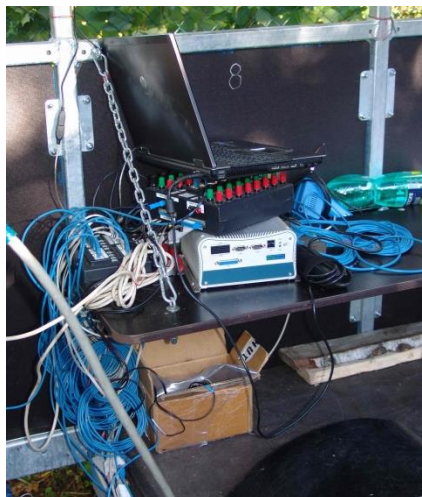
Obr. 5.2 – Měřící vybavení VÚKV a.s., průmyslový počítač a UTP kabely pro připojení snímací techniky
