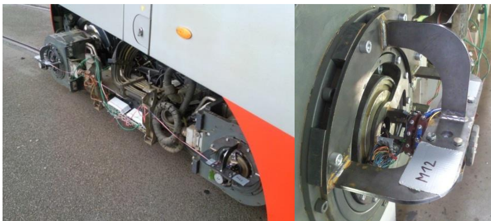
Obr. 7.2 – Tramvaj 15T ForCity – otočný podvozek osazen sensorovou technikou (v levo), detail na přenos signálů z měřícího hřídele (v pravo)
