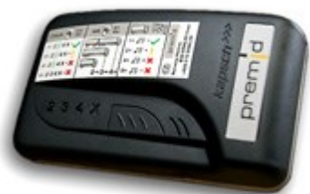
Obrázek 5 Palubní jednotka PREMID (myto.cz)
