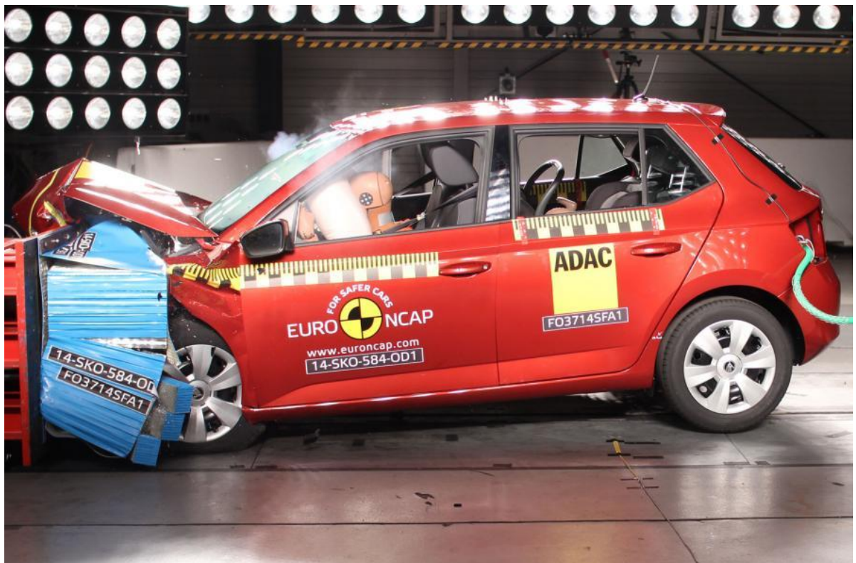
Obr. 1 Čelní náraz podle Euro NCAP [2]
