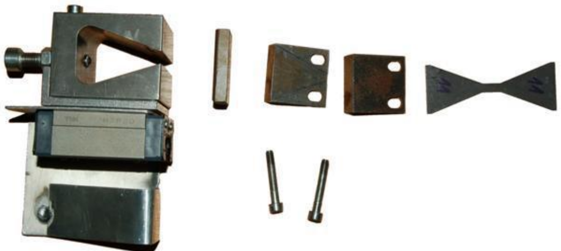
Obrázek 2 Jednotlivé díly tvořící kleštiny a vzorek
