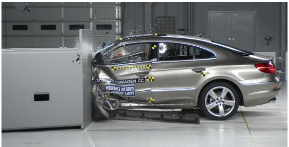
Obr. 2 Čelní náraz podle IIHS [18]
