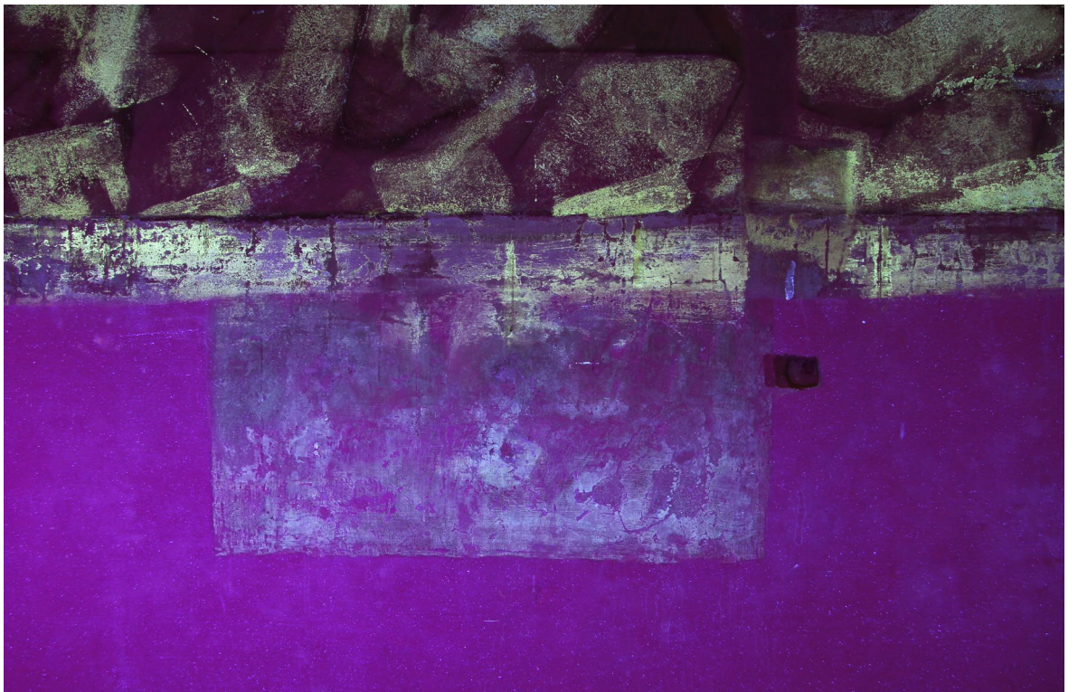
Obr. 66: Detail na soklový úsek pod výjavom č. 1. Stratigrafická sonda. Stav pred reštaurovaním v UV osvetlení. Luminescenciu vykazujú aj fragmenty okrového náter v mieste nezatretého pásu pod výjavom, kvôli obsahu zinkovej bieloby.
