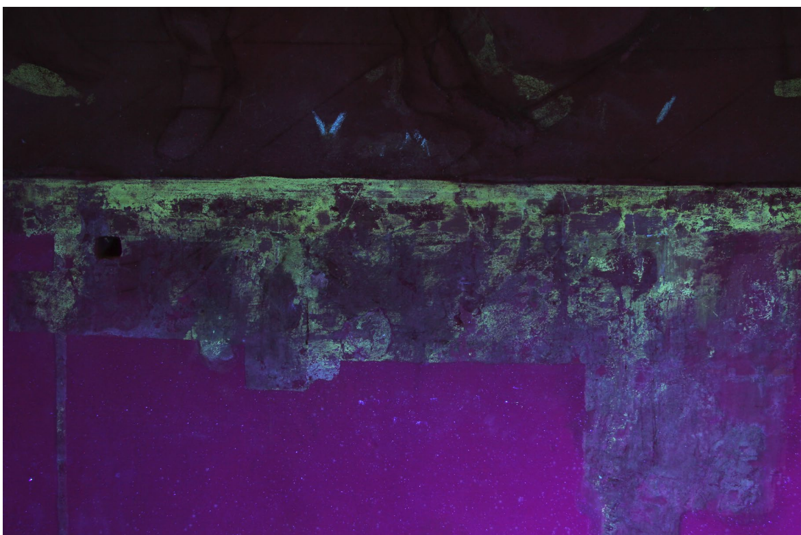
Obr. 67: Detail na soklový úsek pod výjavom č. 4. Stratigrafická rozšírená sonda z roku 2013. Stav pred reštaurovaním v UV osvetlení. Luminescenciu vykazujú aj fragmenty okrového náter v mieste nezatretého pásu pod výjavom, kvôli obsahu zinkovej bieloby. Kresba drapérie sa v UV osvetlení nezvýraznila.
