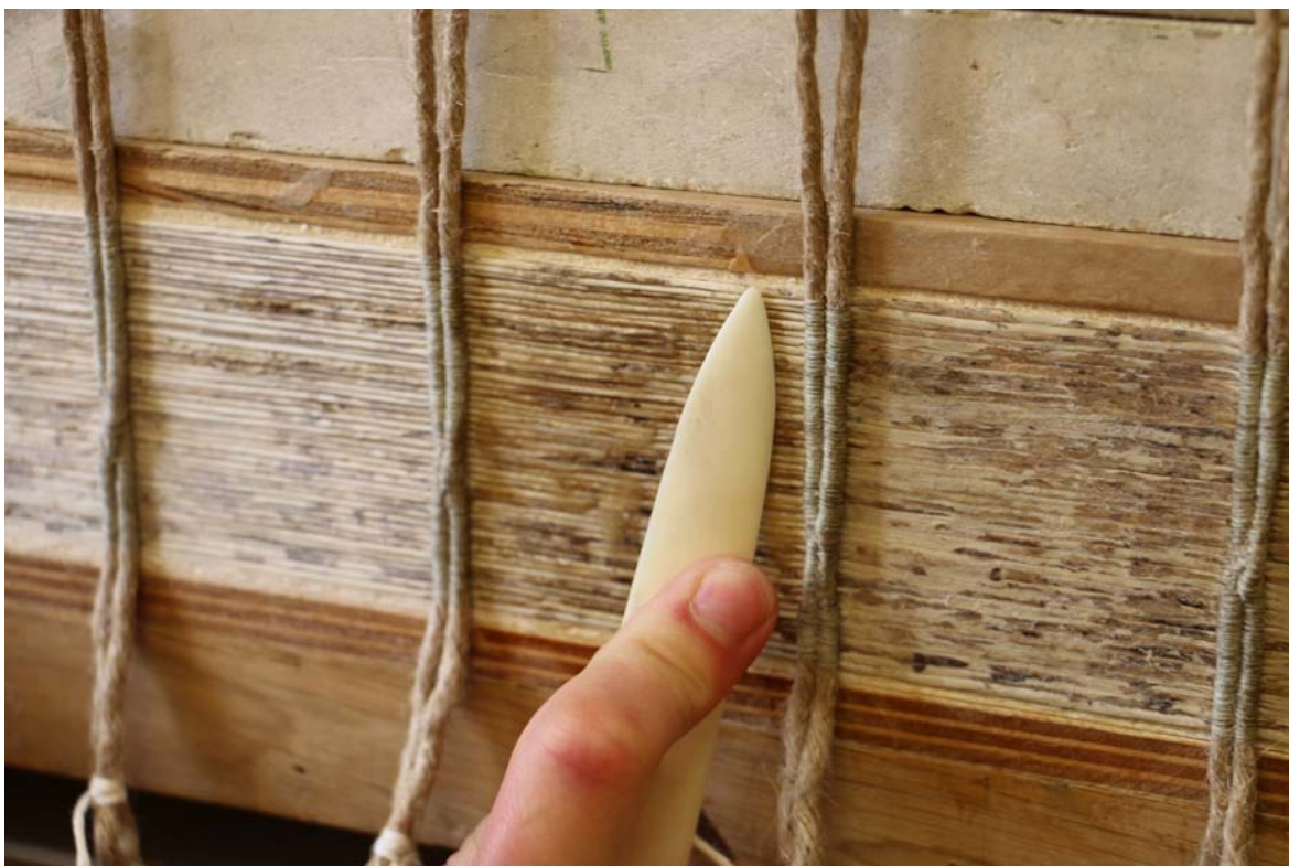
Obr.57 Klížení hřbetu – zpracovávání klišu mezi hřbety složek
