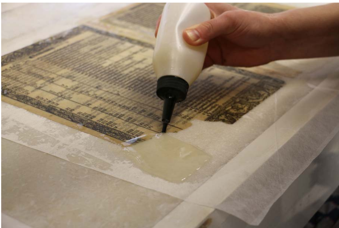
Obr.52 Doplnování ztrát doléváním papírovou suspenzí
