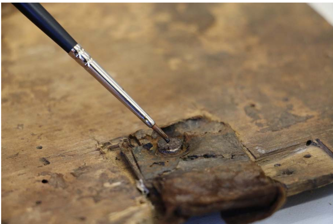
Obr.70 Tanátování železného hřebíku
