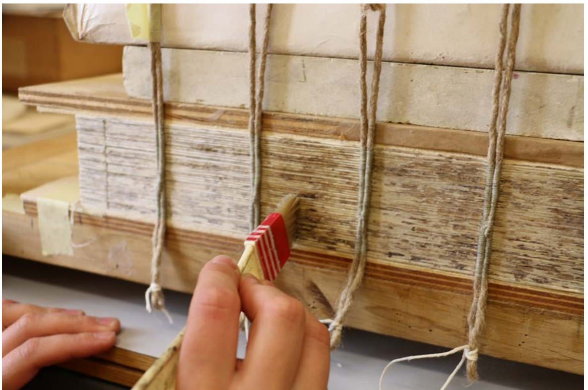
Obr.56 Klížení hřbetu – nanášení klihu
