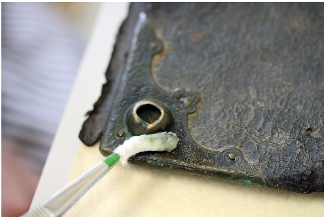
Foto. č. 83 Aplikácie Cheleton III. pomocou vatového tampónu – stav v priebehu reštaurovania
