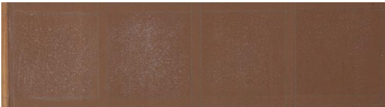
Obr. 17 Pole v řadě D, na kterých byly zkoušeny vápenné suspenze bez následného vlhčení. Konečný stav po navlhčení vodou (celkem 2x navlhčeno).
