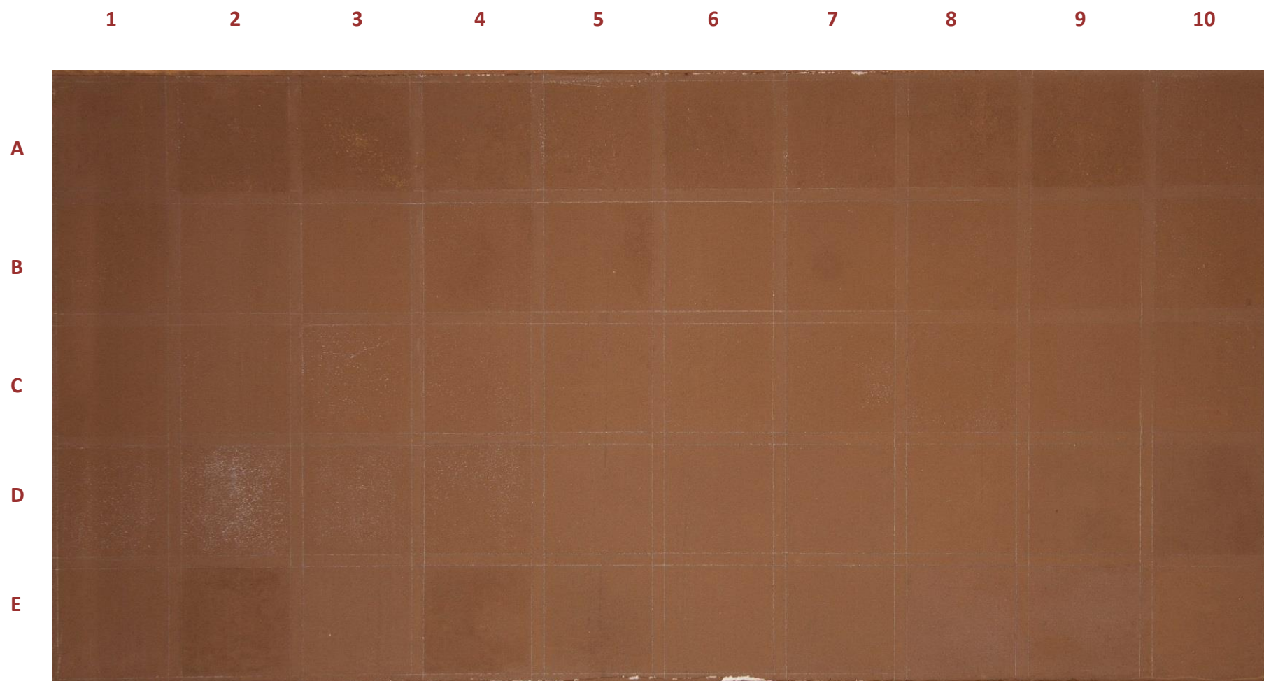
Obr. 15 Testování na zkušebním panelu I, stav po aplikaci všech zpevňujících prostředků
