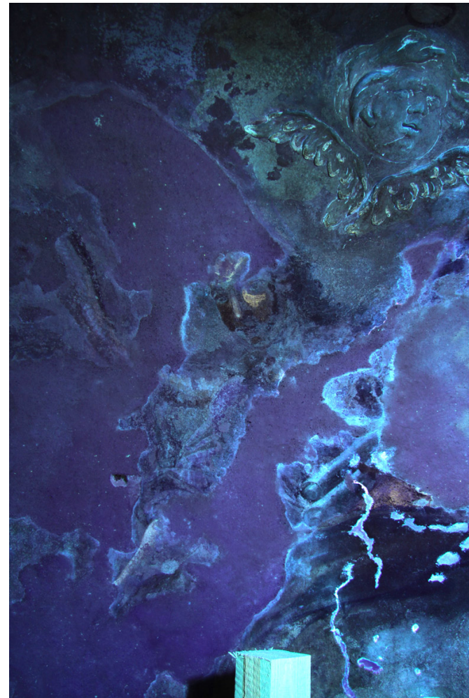
Obr. 62 Fotografie v UV světle, celkový pohled na horní polovinu postavy Archanděla. Zejména v horní části se projevují výrazně luminující místa pravděpodobného výskytu solí (ta září modrozeleně). V místě inkarnátu se objevuje specifická žlutooranžová luminiscence.
