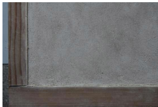
Obr. 13 Průběh přípravy zkušebních panelů, nanesení intonaca s nižším obsahem pojiva
