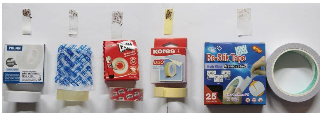
Obr. 25 Testované lepicí pásky s různou lepidivostí a velikostí. K odtrhovému testu I byla zvolena třetí páska zleva.
