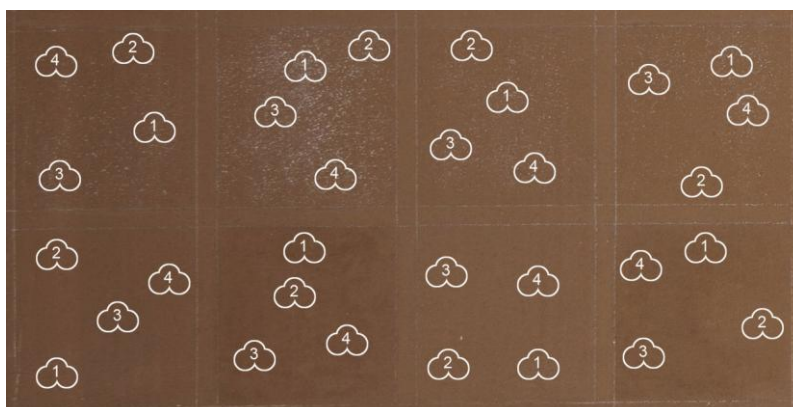
Obr. 20 Ukázka označení míst měření bílého zákalu (body 1-4) spektrofotometrem na zkušebním panelu
