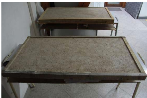
Obr. 12 Průběh přípravy zkušebních panelů, nanesení jádrové omítky
