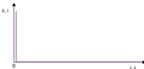
Obr. 3.5 – PCH regulátoru typu D
