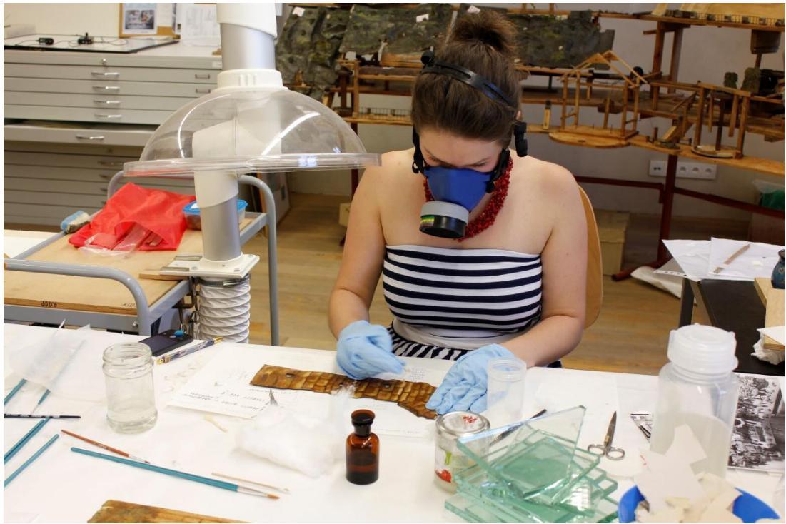
Obr. 127: Zkoušky odstraňování lakových vrstev – chloroform
