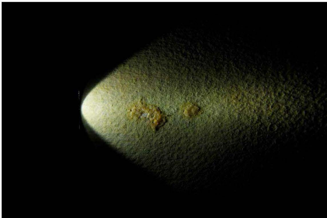
Obr. č. 450 Špatně rozmíchaný pigment a žloutek – autorská chyba. Detail v bočním osvětlení.
