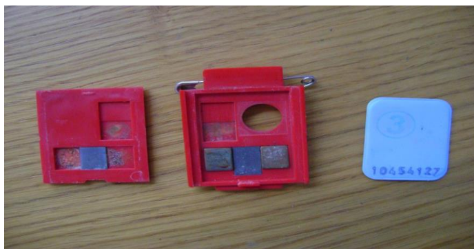
Obrázek 8 Otevřený filmový dozimetr, Zdroj (4)
