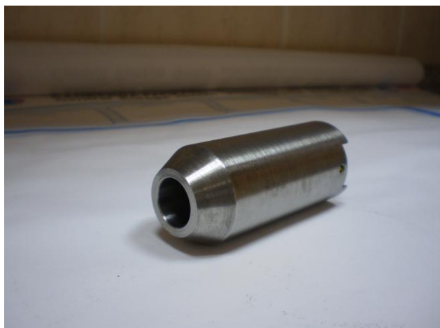
Obrázek 15 Kryt na stříkačku s FDG (vlastní zdroj)
