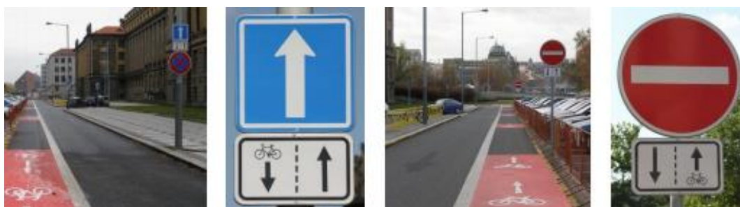
Obrázek 12: Svislé a vodorovné dopravní značení IP4b + E12a a B2 + E12b
