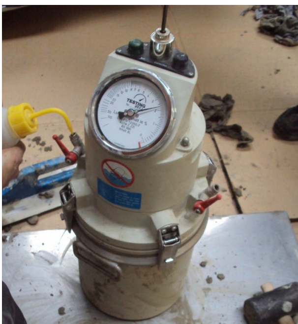
Obr. 23: Zkouška obsahu vzduchu
