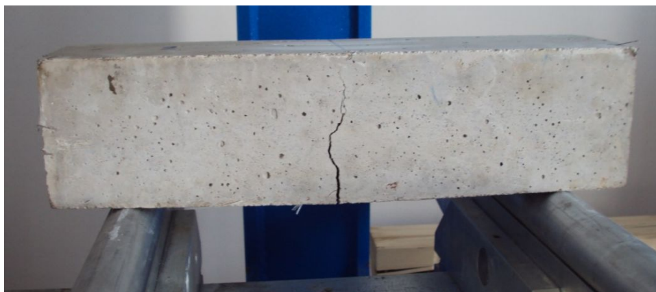
Obr. 45: Zkouška v tahu ohybem u hranolu ze záměsi Z4II
