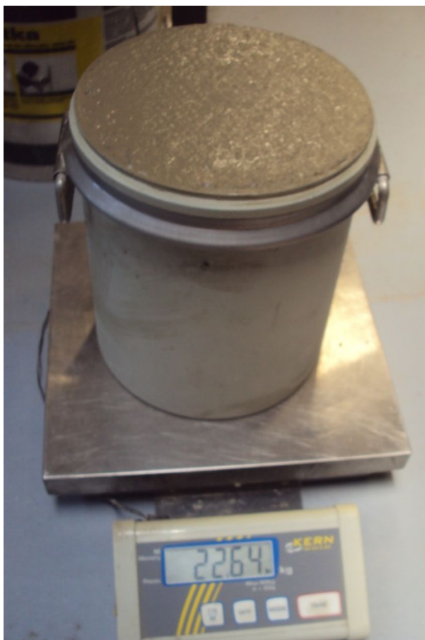
Obr. 22: Zkouška objemové hmotnosti čerstvého betonu, záměs Z1R
