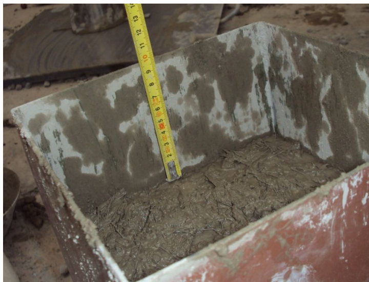
Obr. 21: Zkouška stupně zhutnitelnosti pro záměs Z3I
