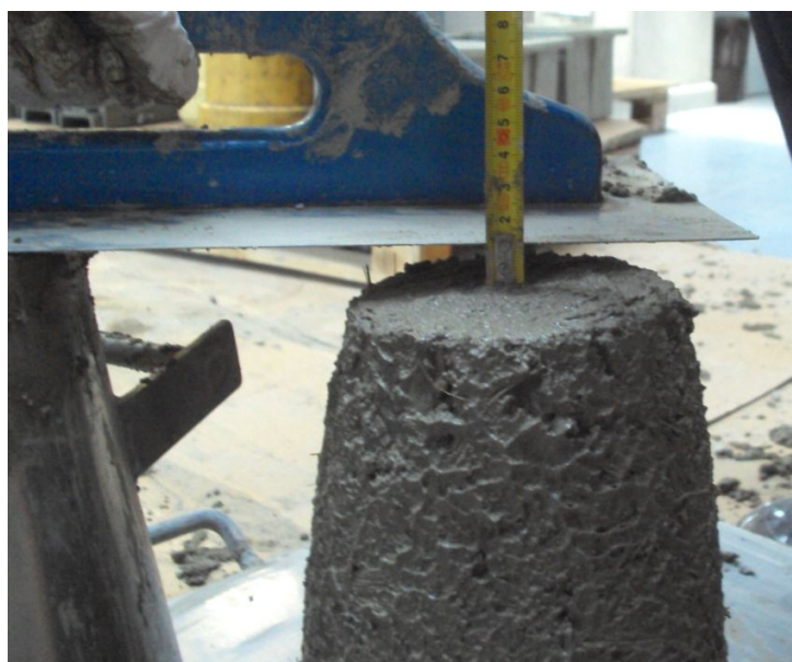
Obr. 20: Zkouška sednutím pro záměs Z2PP
