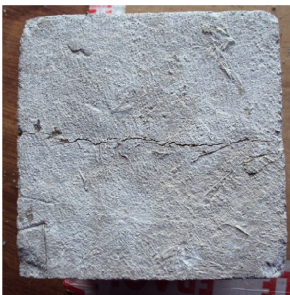
Obr. 44: Porušení krychle záměsi Z4II po zkoušce příčným tahem
