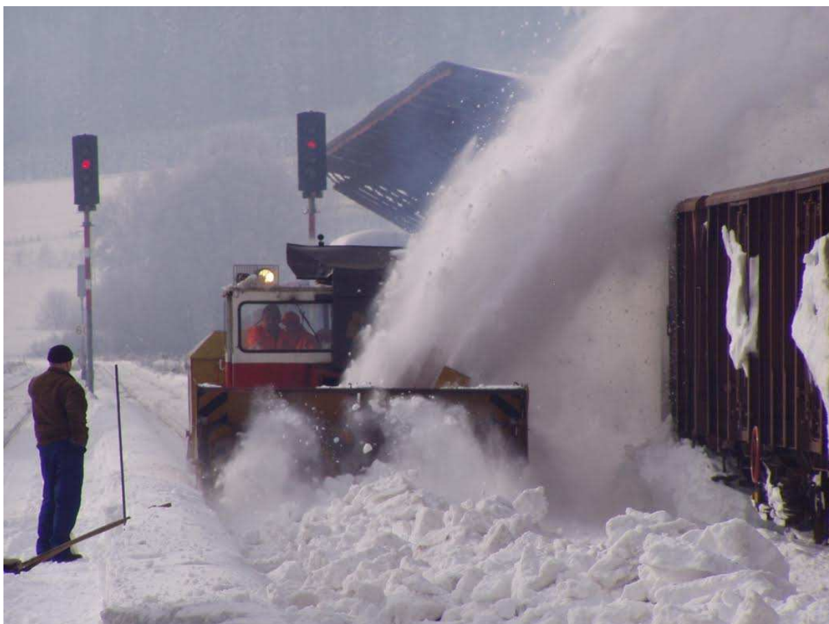
25 Sněhová fréza odstraňující sníh z kolej 1; zdroj: archiv Romana Kozáka
