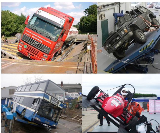
Obrázek 3 - Zkouška na sklopné plošině
