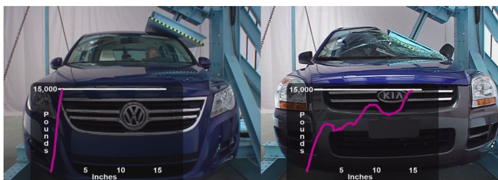
Obrázek 7 - Test pevnosti střechy se stejnou zatěžovací silou
