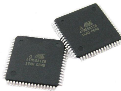
Obrázek 4.1 – Mikroprocesor ATmega128 v pouzdře TQFP [Dunia Elektronika, 2015]
