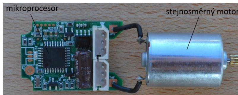
Obrázek 4.8 – Řídicí jednotka a stejnosměrný motor servopohonu Dynamixel AX-12A
