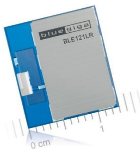
Obrázek 3.2 – Komunikační modul Bluegiga BLE121RL [Bluegiga, 2015]
