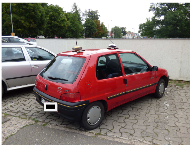
Obrázek 48 Vozidlo Peugeot 106 se záznamovým zařízením DVRB4 a referenčními zařízeními (autor)
