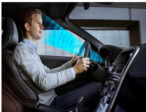
Obrázek 24 Detekce únavy pomocí infračerveného záření Volvo (Volvo, 2007)
