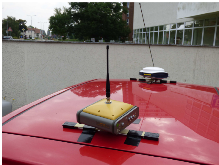
Obrázek 47 Vozidlo Peugeot 106 s umístěnými referenčními zařízeními (autor)
