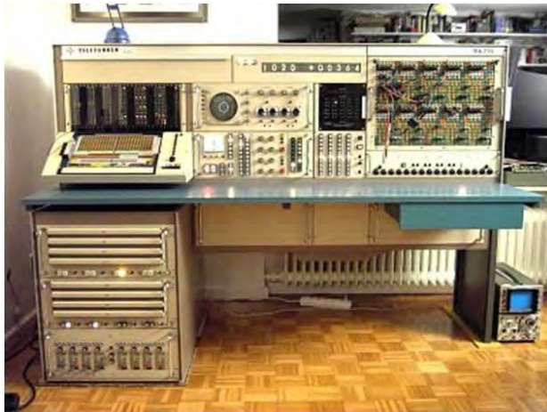
Pracoviště analogového počítače a jeho základní organizační schéma (Zdroj 29 ).
