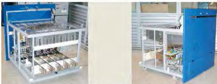
Obr. 37 Dva pohledy na vozík skříňového měniče – zezadu jsou nahoře dobře viditelné chladiče diodového bloku a dole kontaktní hlavice silového přípojení [10]
