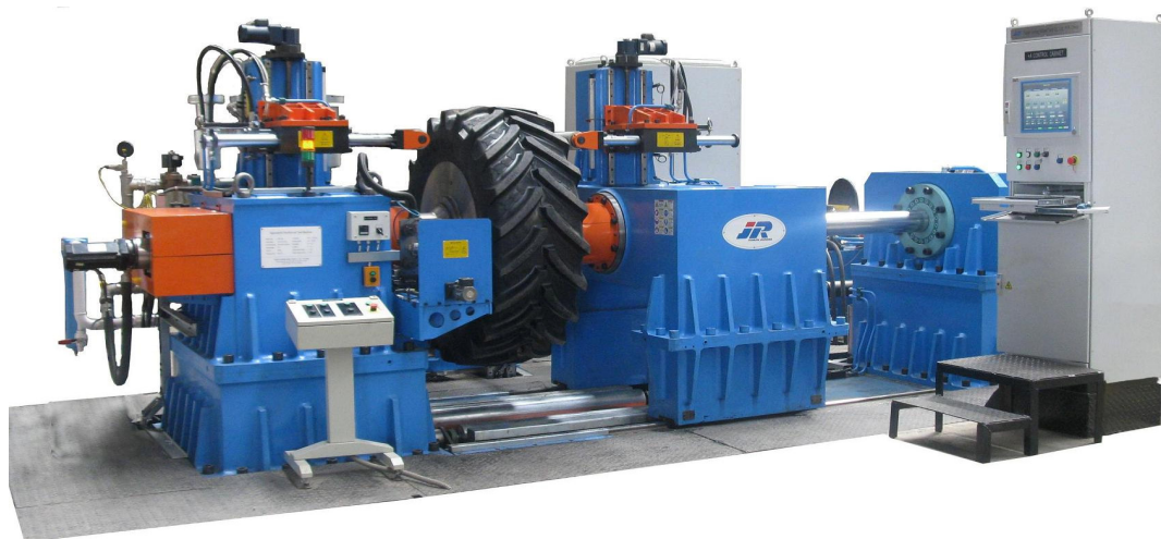
Obr. 16 - Zkušební zařízení radiální a axiální házivosti [10]
