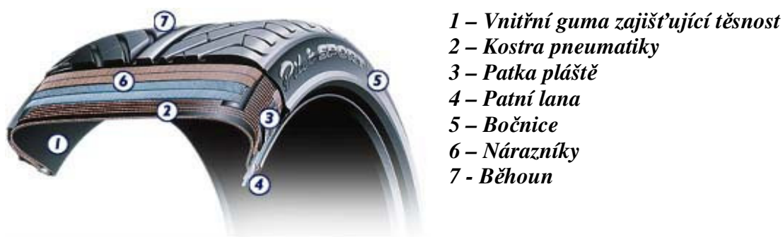
Obr. 7 - Základní konstrukce pneumatik [3]
