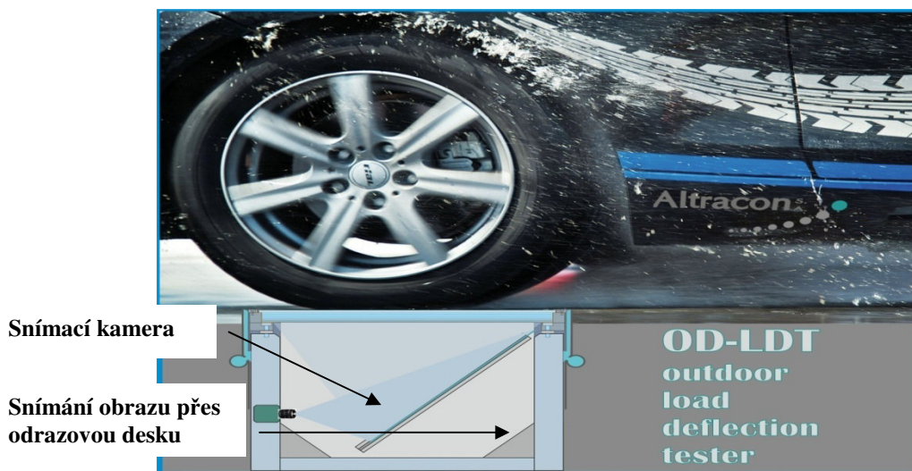
Obr. 19 - Zkušební zařízení OD-LDT při zkoušce [13]
