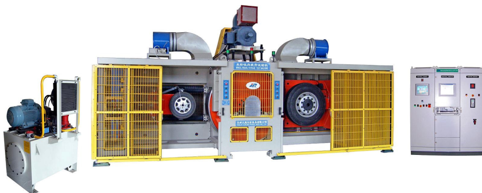
Obr. 17 - Radiální zkušební zařízení RTF-7[11]
