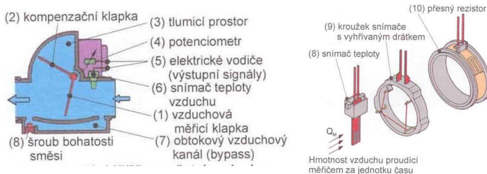
Obrázek 3: Měřič množství nasávaného vzduchu L-Jetronic [2]
